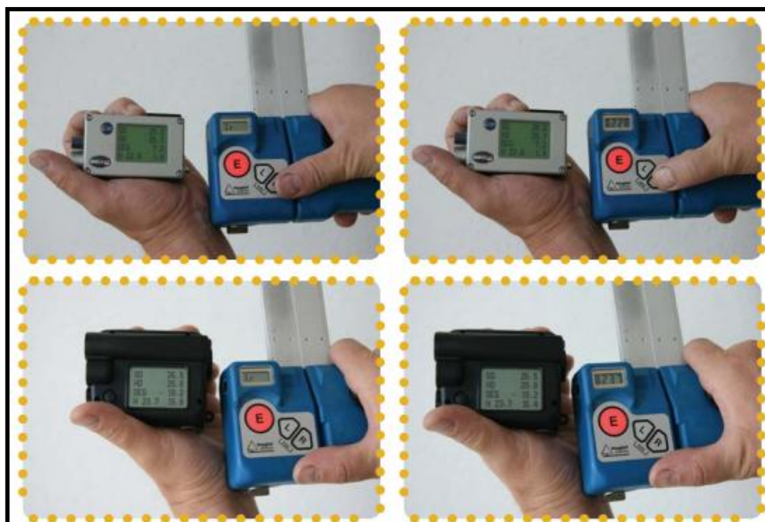
Příloha č. 6: Moderní dendrometrické přístroje a přenos dat mezi nimi.
