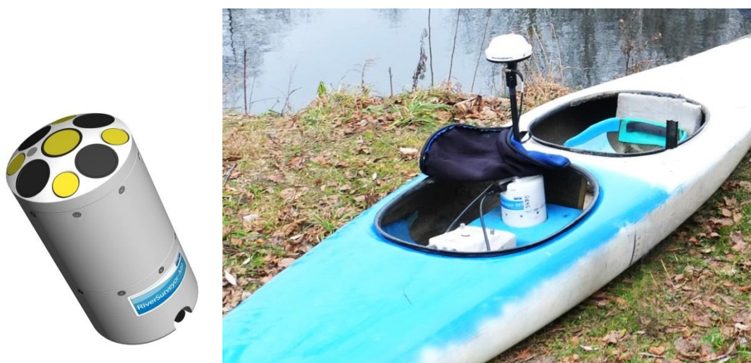
Obrázek 7: vlevo pohled na hlavici echosounderu M9, vpravo již umístěn v lodi
