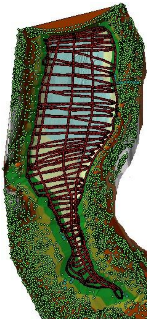
Obrázek 16: Pokrytí dat v zájmovém území (červeně měření echosounderem, zeleně WMS - DMR 5G a modře GPS přístroj)
