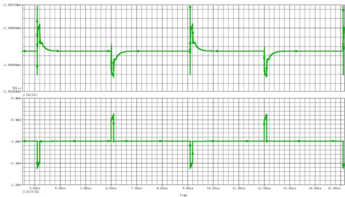
Obr. 34: Simulace zdroje proudů – výstupní proudy obou větví do zátěže V13
