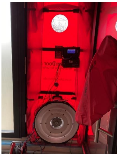
Obrázek 15 - Minneapolis Blowerdoor (autor práce, 2024)
