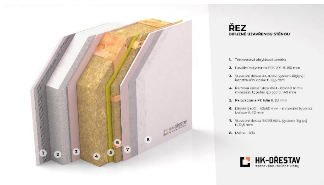
Obrázek 6 - difúzně uzavřená konstrukce HK – DŘESTAV (HK – Dřestav, 2023).
