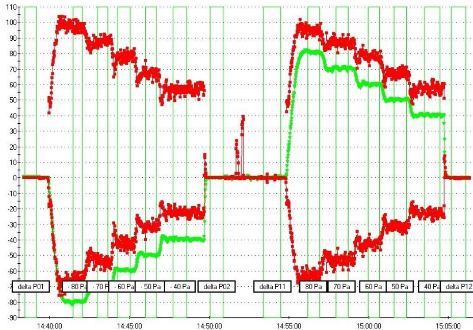
Graf 2 - graf časového průběhu vyvolaných tlaků po dobu měření vzduchové neprůvzdušnosti (Loira ©2023).
