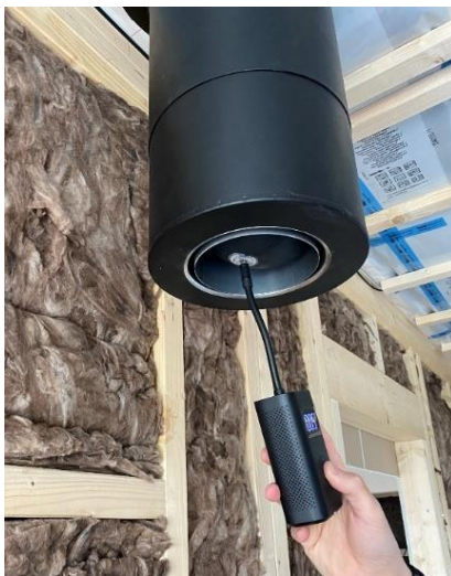
Obrázek 14 - příklad použití těsnícího balónku a hustilky (autor práce, 2024)
