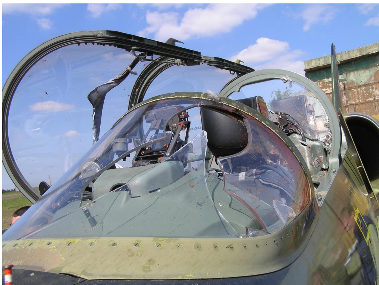
Obr. č. 7: Sřet káněte s letounem L-39 ZA-Albatros. Došlo k poškození předního štítu kabiny a následné vniknutí zbytků dravce a štítku do prostoru kabiny pilota (zdroj AČR)
