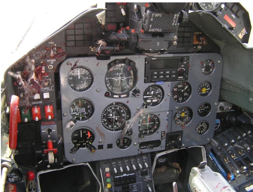
Obr. č. 10: Palubní přístrojová deska po střetu (zdroj AČR)
