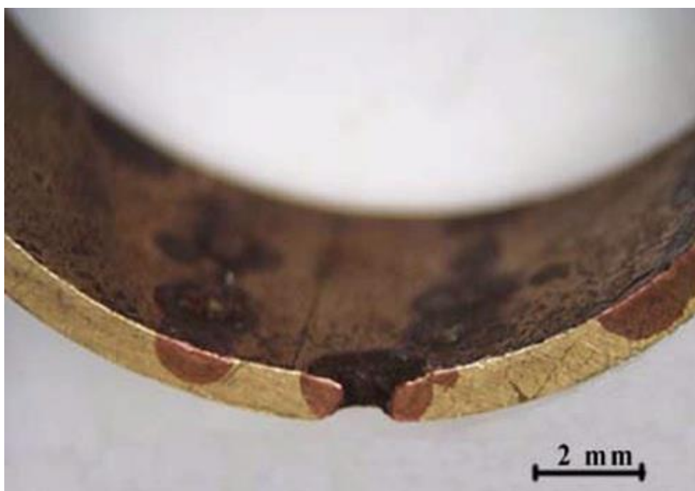
Obr. 9 Selektivní koroze Zdroj: http://old.vscht.cz
