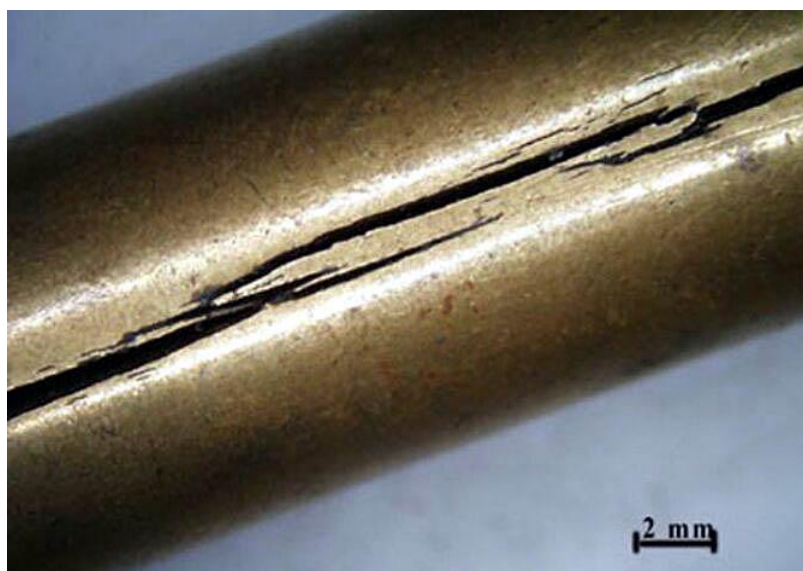
Obr. 11 Praskání mosazných nábojnic Zdroj: http://old.vscht.cz
