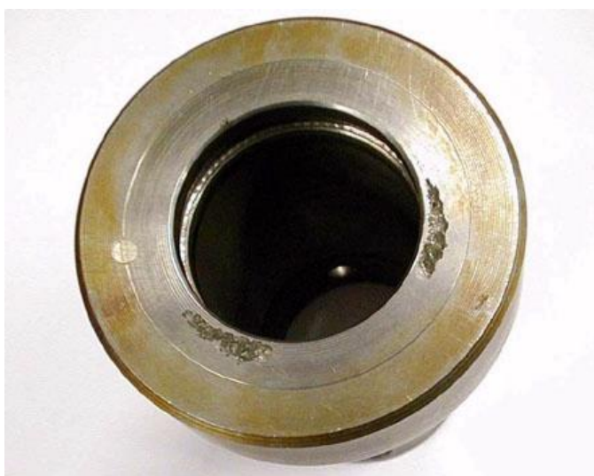
Obr. 6 Štěrbínová koroze pod těsněním Zdroj: http://old.vscht.cz
