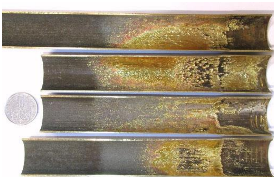
Obr. 13 Erozní poškození Zdroj: http://old.vscht.cz
