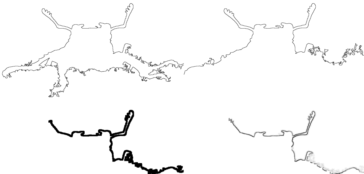
Obrázek 20 – Získání stabilních hran; hrany regionu na úrovni 22 (vlevo nahoře), hrany otcovského regionu na úrovni 10 (vpravo nahoře), odpovídající segment validní hrany a jeho okolí (vlevo dole), ekvivalentní hodnoty zapsané do saliency image (vpravo dole)
