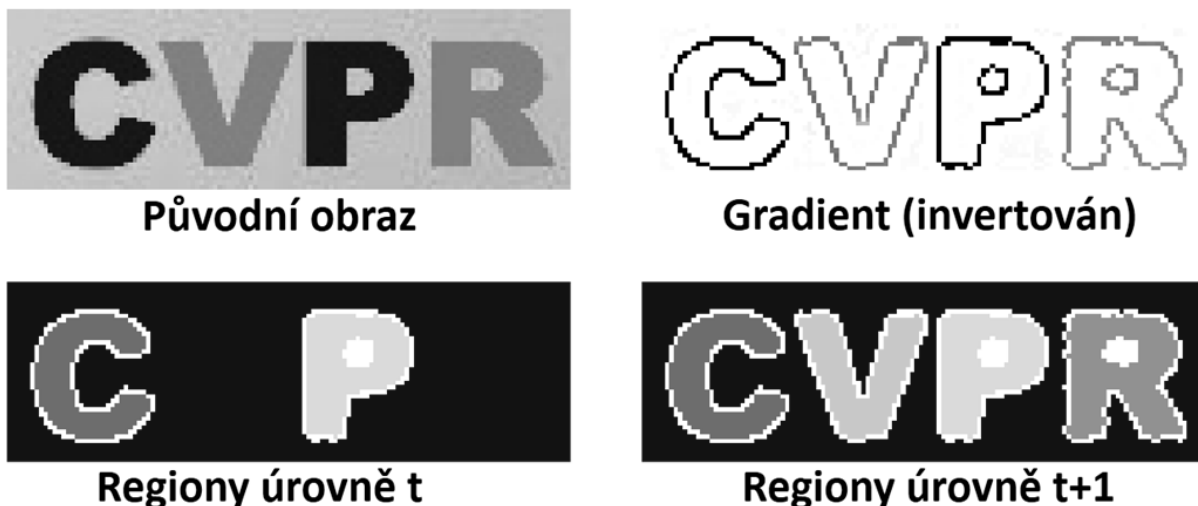
Obrázek 18 – Regiony nalezené postupným prahováním gradientu (převzato z [2])
