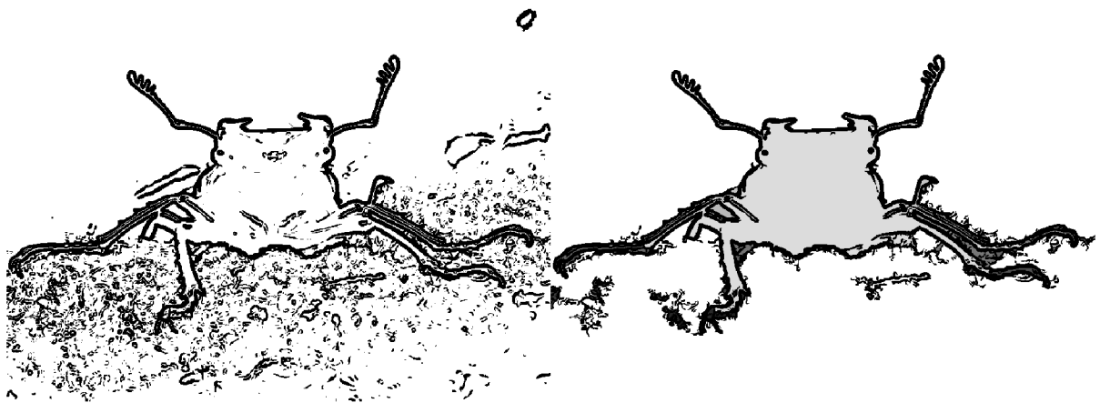
Obrázek 24 – Regiony vniklé prahováním (bílé) před (vlevo) a po vyplnění děr a detekci regionů (vpravo)
