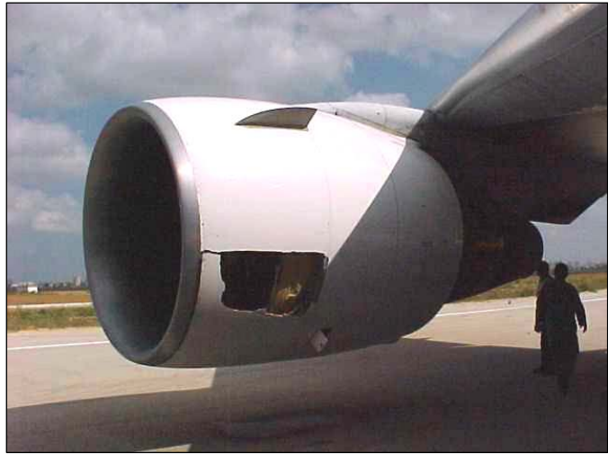
P2-11: Motor B767 po nasátí několika racků
