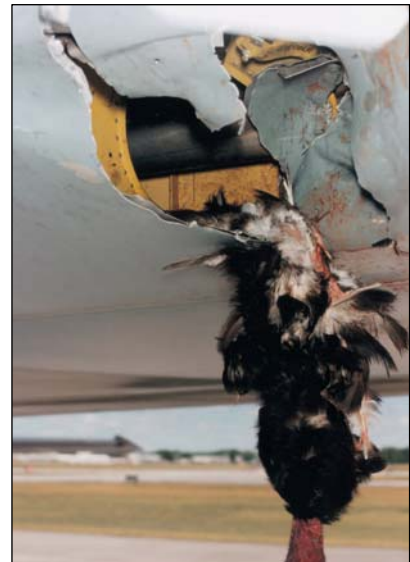
P2-8: Střet může vést k poškození systémů a konstrukce
