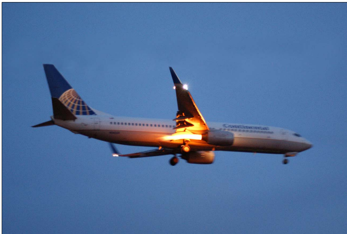
P1-7: Boeing 737 nasál husu (1200 ft AGL) při přistání na letišti Newark-Liberty (New Jersey)
