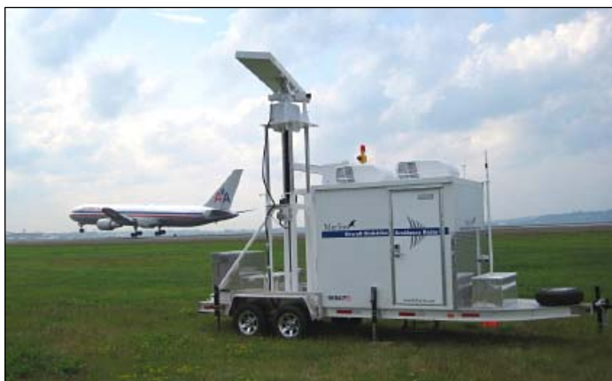
P8-1: Mobilní radary jsou spolehlivým způsobem detekce ptáků (Merlin vpravo, Accipiter vlevo)
