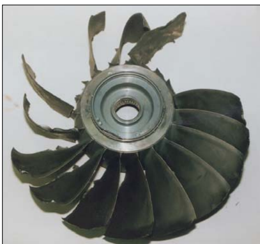
P2-13: Motor malého proudového letounu po srážce s Kondorem krocanovitým vážícím 1,3 kg (vzlet, rychlost 140 kt)
