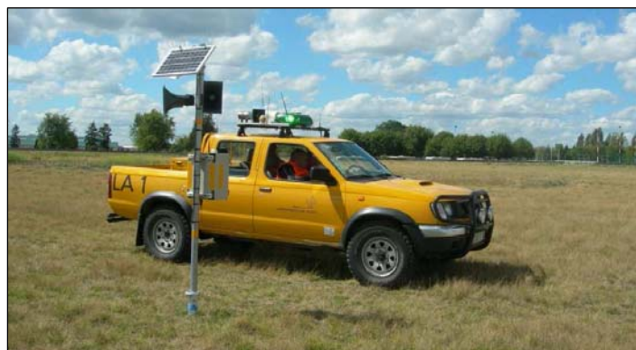
Obr. 24: Dálkově ovládaný hlukový plašič
