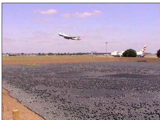
Obr. 9: Použití míčků na vodní ploše jako prevence proti přistávání ptáků
