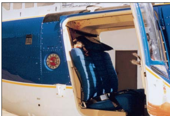
P2-16: Značné poškození vrtulníku Bell Jet Ranger způsobil střet s Potápkou západní (1,3 kg). Po proražení předního skla (vlevo nahoře) byl pilot zasažen do obličeje. Helma s čelním štítkem nejspíš pilotovi zachránila život. Náraz byl natolik silný, že po zásahu předního skla a pilota pták ještě poškodil závěsy zadních dveří.
