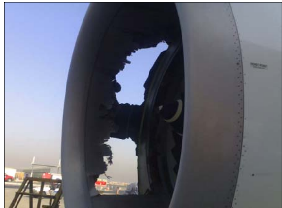
P2-12: Motor Rolls Royce (Airbus A330) – příčina neznámá (pravděpodobně nasátí ptáka)
