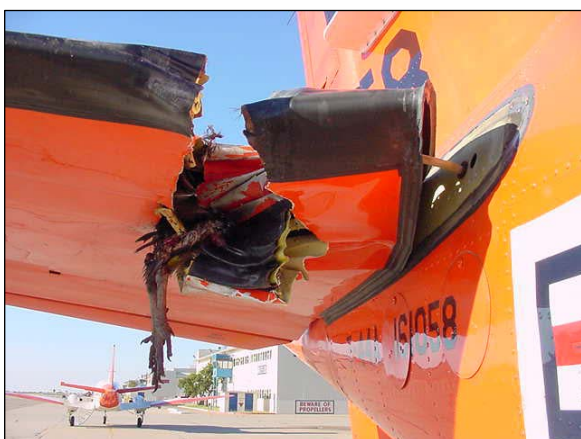
P2-9: Výškové kormidlo letounu Beechcraft King Air 90 po nárazu Kondorem krocanovitým (Texas)
