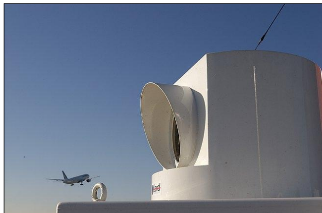
P8-9: Automatický laserový systém TOM 500 využívající k plašení „stick“ efektu
