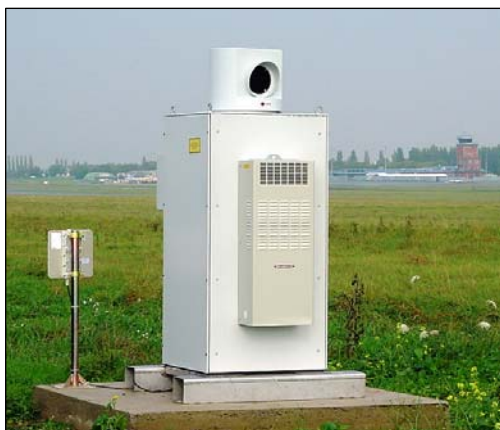
P8-9: Automatický laserový systém TOM 500 využívající k plašení „stick“ efektu
