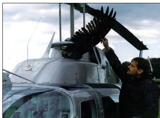
P2-22: Bell Jet Ranger po střetu s ptákem
