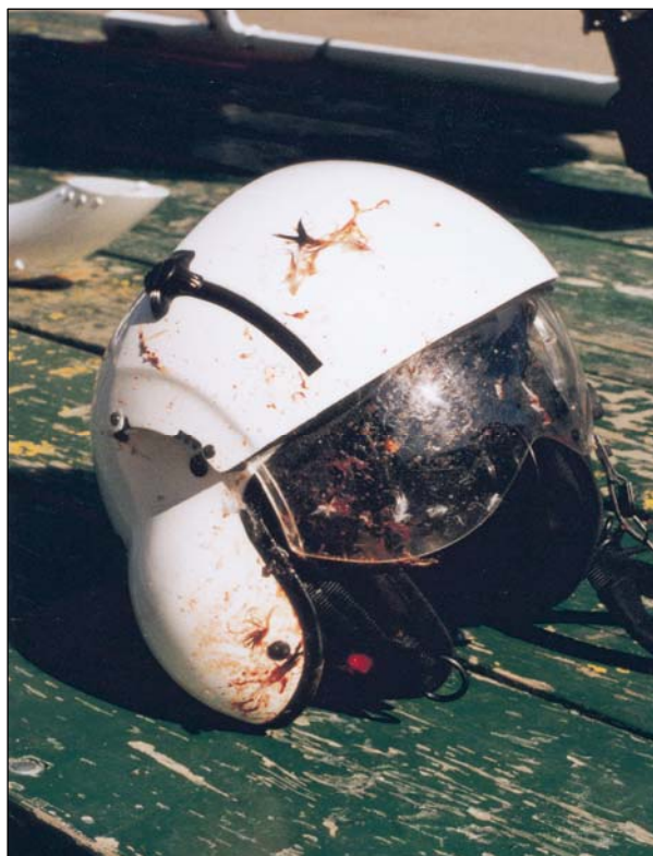
P2-16: Značné poškození vrtulníku Bell Jet Ranger způsobil střet s Potápkou západní (1,3 kg). Po proražení předního skla (vlevo nahoře) byl pilot zasažen do obličeje. Helma s čelním štítkem nejspíš pilotovi zachránila život. Náraz byl natolik silný, že po zásahu předního skla a pilota pták ještě poškodil závěsy zadních dveří.
