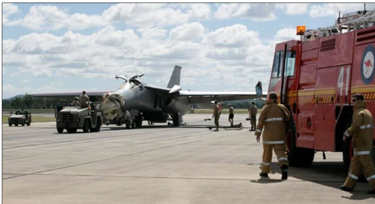
P2-21: Letoun F-111 po střetu s pelikánem při tréninkové misi (Austrálie)
