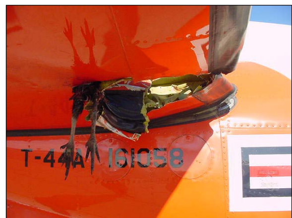
P2-9: Výškové kormidlo letounu Beechcraft King Air 90 po nárazu Kondorem krocanovitým (Texas)
