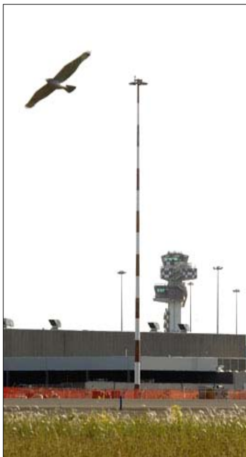
P8-2: Testování RC modelu Falco Robot (ve tvaru jestřába) na letišti Fiumicino v Římě
