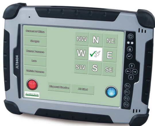
P8-7: Obrazovka potvrzení akce plašení a záznamu efektu plašení
