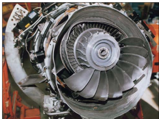
P2-13: Motor malého proudového letounu po srážce s Kondorem krocanovitým vážícím 1,3 kg (vzlet, rychlost 140 kt)
