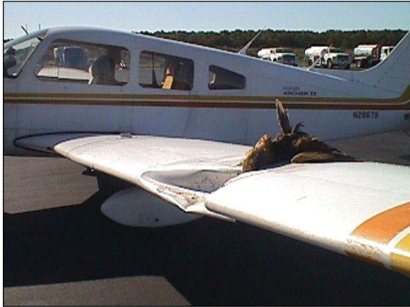
P2-6: Piper PA-28 Warrior po srážce s Bukačem severoamerickým (Atlantic City)
