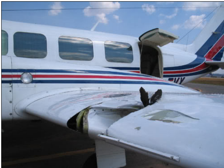
P2-7: Křídlo letounu Piper PA-31 (pták neznámý)
