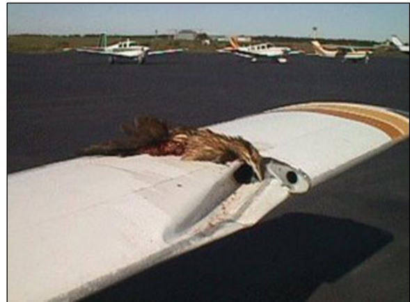
P2-6: Piper PA-28 Warrior po srážce s Bukačem severoamerickým (Atlantic City)
