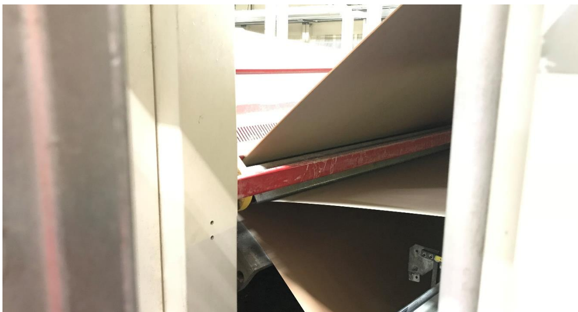
Obrázek 11 Finální slepení dvou otevřených vln a krycího papíru
