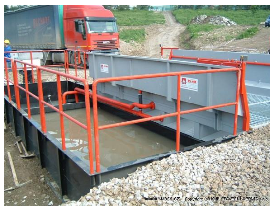
Obr. 4.10. a 4.11. Očistná rampa bude umiestnená na výjazde zo staveniska
