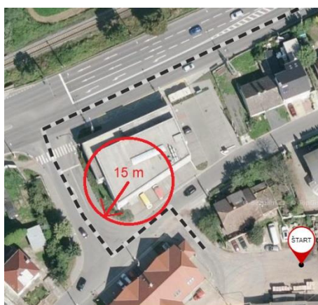
Obr. 10.2 Kritické miesto pri doprave vrtnej súpravy
