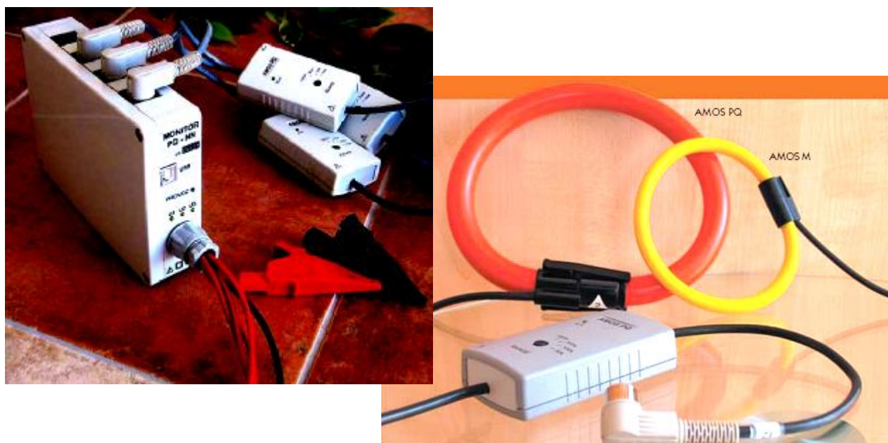
Obr. 8-1: PQ monitor Meg 30 a meracie transformátory prúdu s nastaviteľným rozsahom
