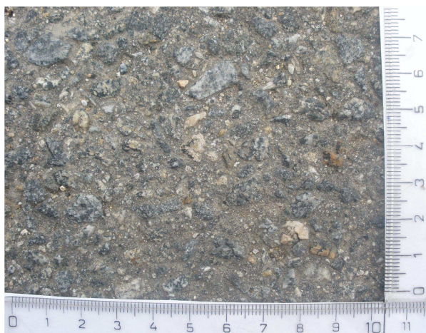
Obr 7: Drsnost povrchu testovací dráhy
