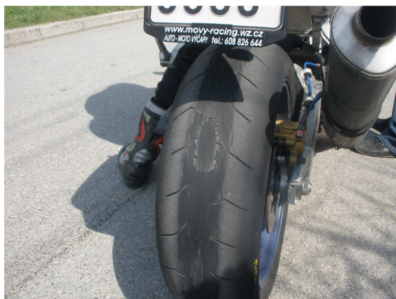
Obr 37: Opotřeбенí zadní pneumatiky po testech
