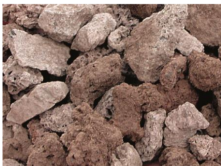
Obr. č. 27 - Minerální drenáž ( http://www.bauder.cz/cz/vegetacni-strecha/produkty-pro-vegetacni-strechu/drenazni-a-vodu-zadrzujici-vrstva/mineralni-drenaz-bauder-bs-211-l-211.html )
