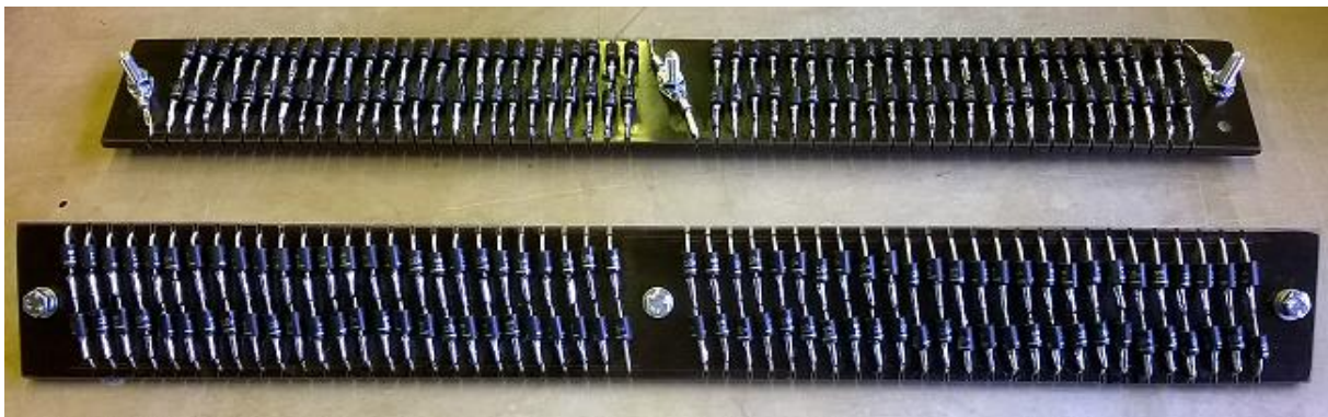
Obrázek 7: Provedení můstkového usměrňovače (Graetzův můstek)
