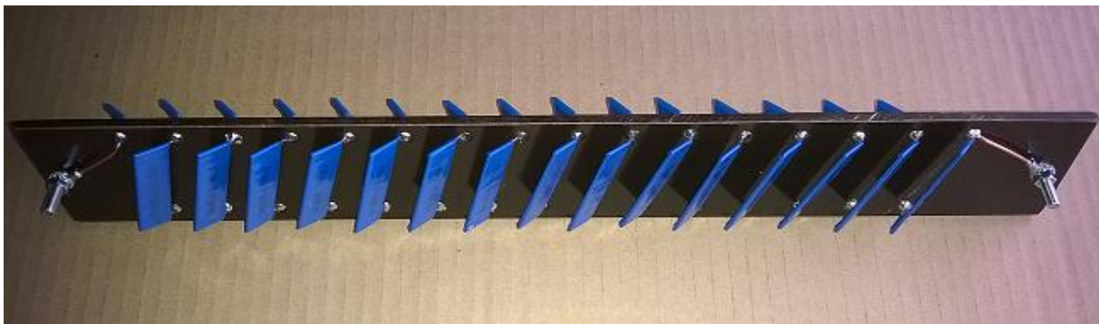
Obrázek 9: Vysokoohmový “měřicí“ rezistor
