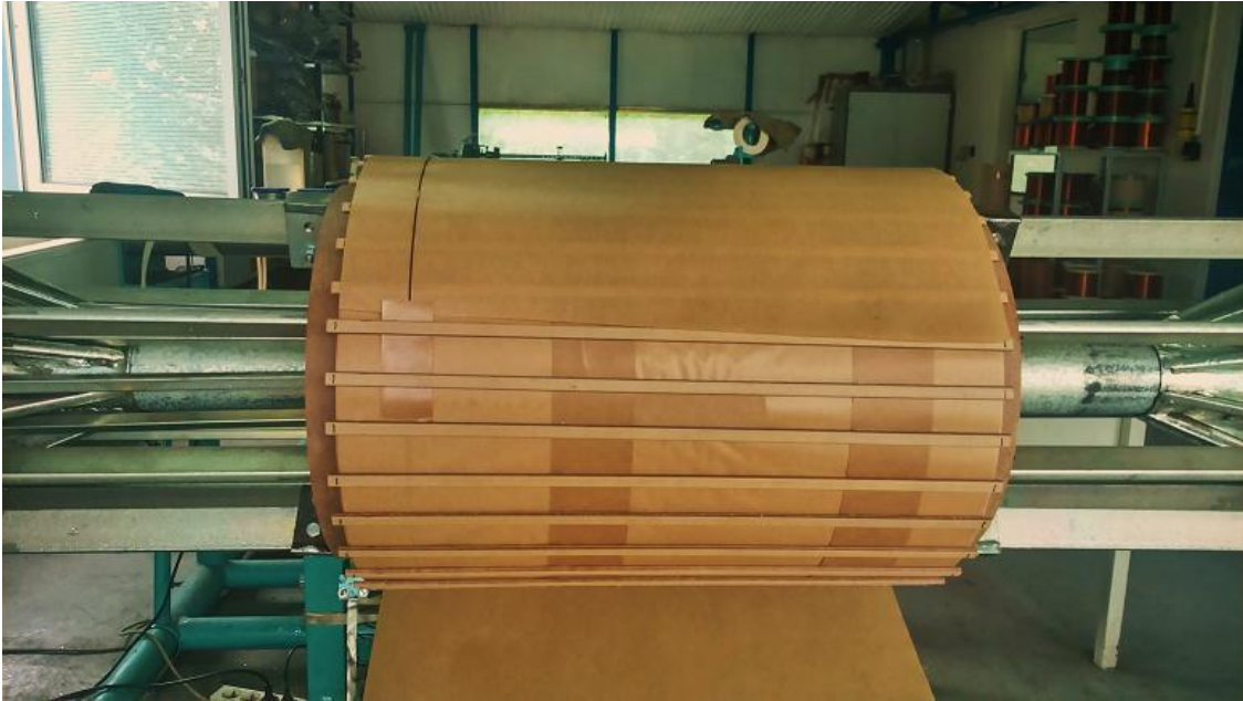
Obrázek 4: Navíjení vysokonapěťové cívky s proklady na cirkulaci oleje pro lepší chlazení vinutí
