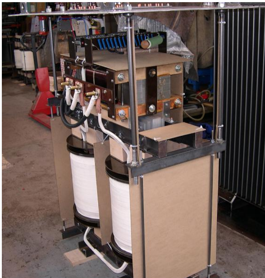
Obrázek 5: Vnitřní provedení transformátoru
