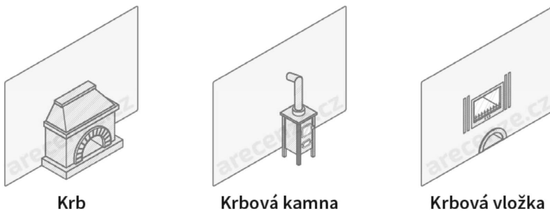
Obrázek 6 – schématický rozdíl mezi krbem, krbovými kamny a krbovou vložkou
