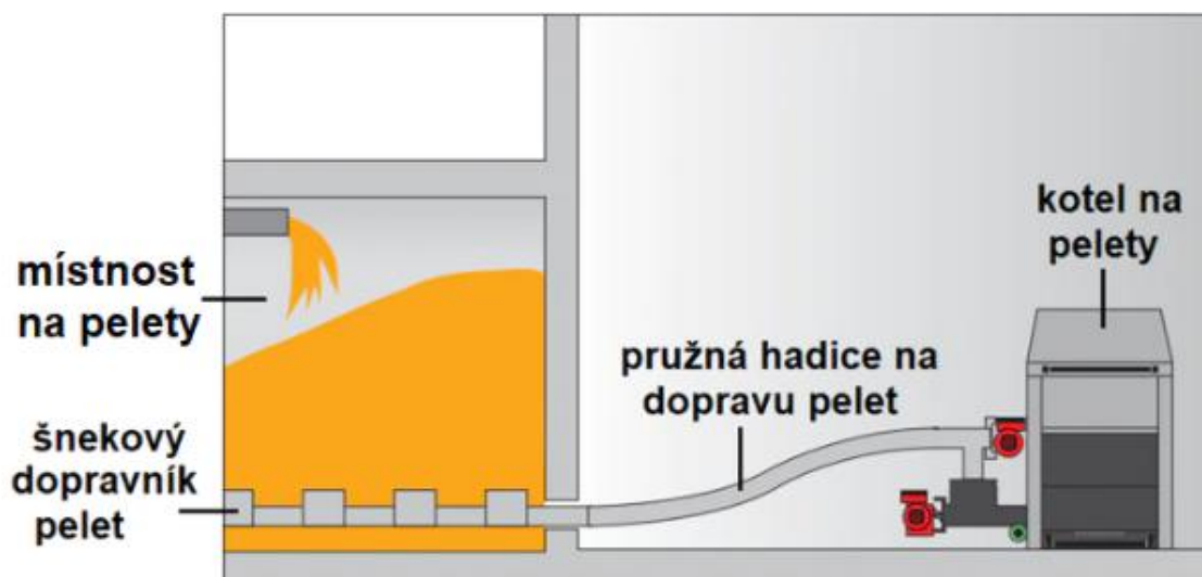
Obrázek 9 – kotel s odebíráním pelet z oddělené místnosti
