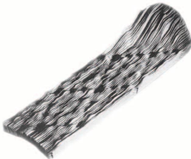
Obrázek 3.7: Jeden z prvních snímků s atomárním rozlišením. Model povrchu křemíku (111) slepený z jednotlivých snímaných profilů. Převzato z [9]
