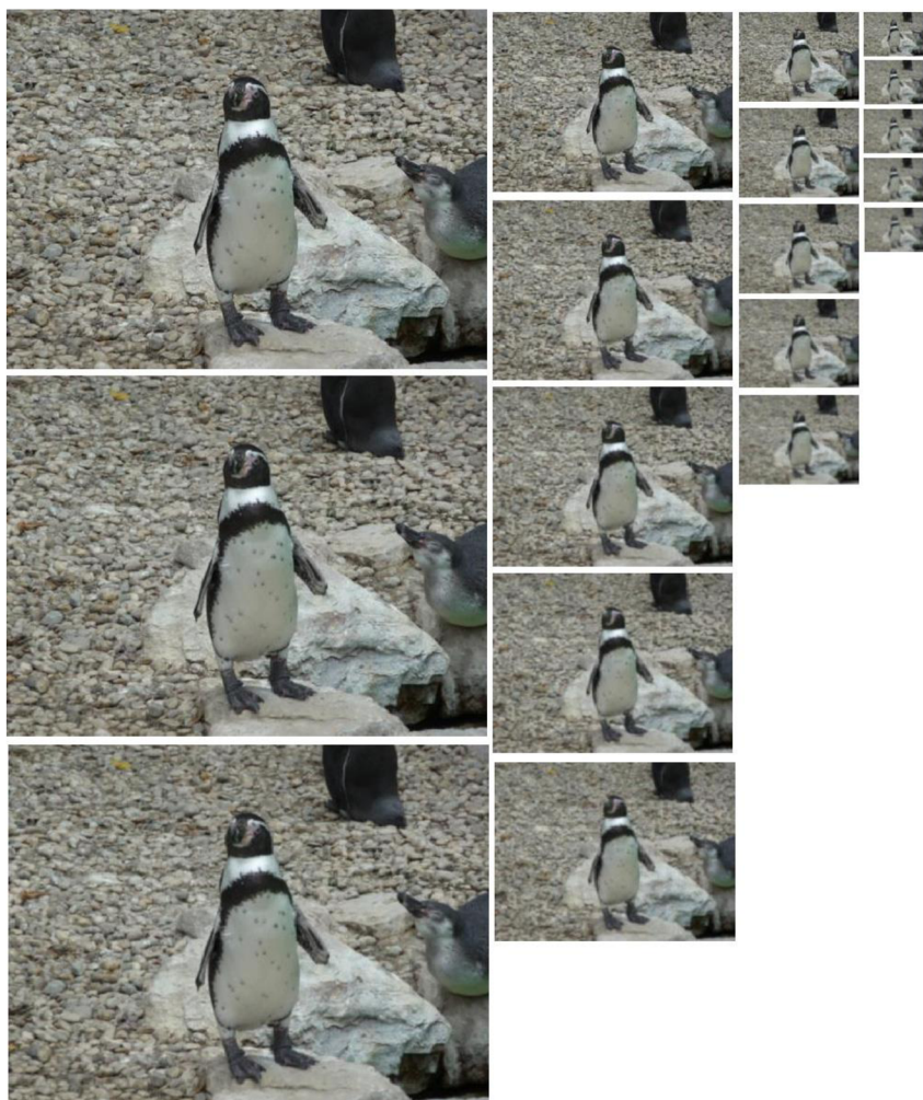
Obr. 1.9: Škálovacia pyramída so 4 oktávami a 5 obrazmi v každej oktáve. Obrazy sú vkaždej oktáve filtrované Gaussiánom. [12]
