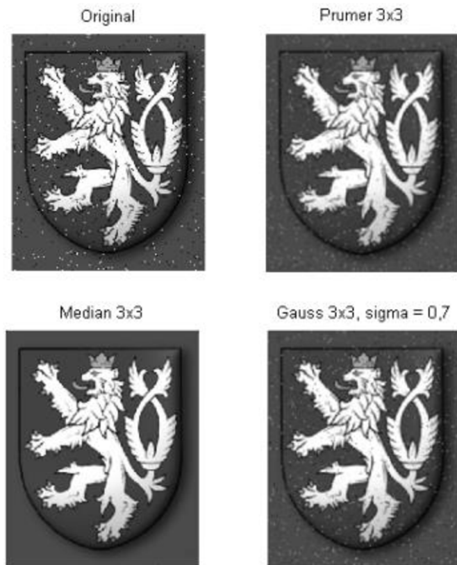
Obr. 1.2: Porovnanie filtrácie jednotlivých metód, pôvodný obraz má pridaný šum korenie a soľ s hustotou 0,02 [17]
