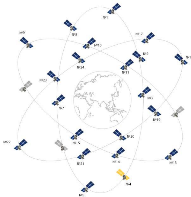
Obr. 6: Rozmístění družic GLONASS a jejich dráhy okolo Země Zdroj: http://www.spacecorp.ru/en/directions/glonass/orbital/
