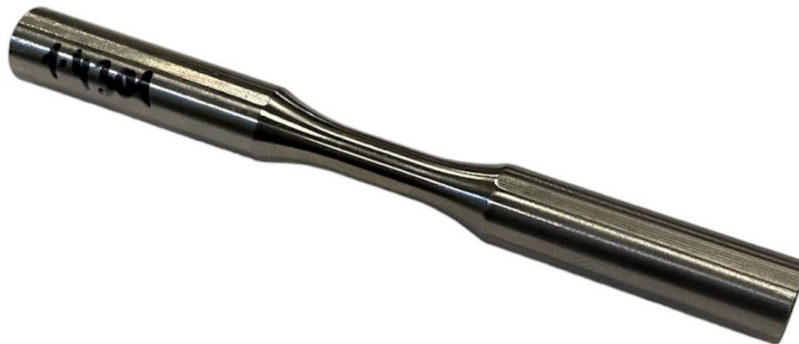
Obr. 3.13 Reálný vzorek pro únavovou cyklickou zkoušku
