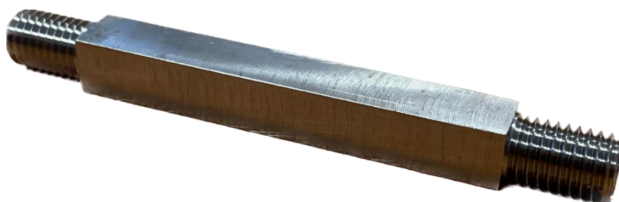
Obr. 3.2 Tvar vzorku využitý pro aplikaci teplotních cyklů a následné měření zbytkových napětí rentgenovou difrakcí
