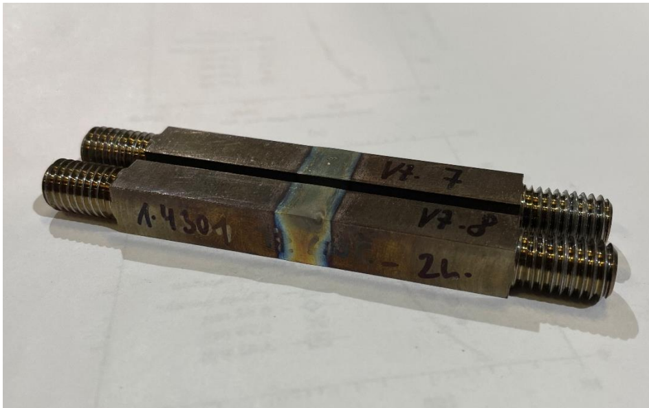
Obr. 3.7 Vzorky podrobené teplotnímu cyklu s maximální teplotou 1366 °C
