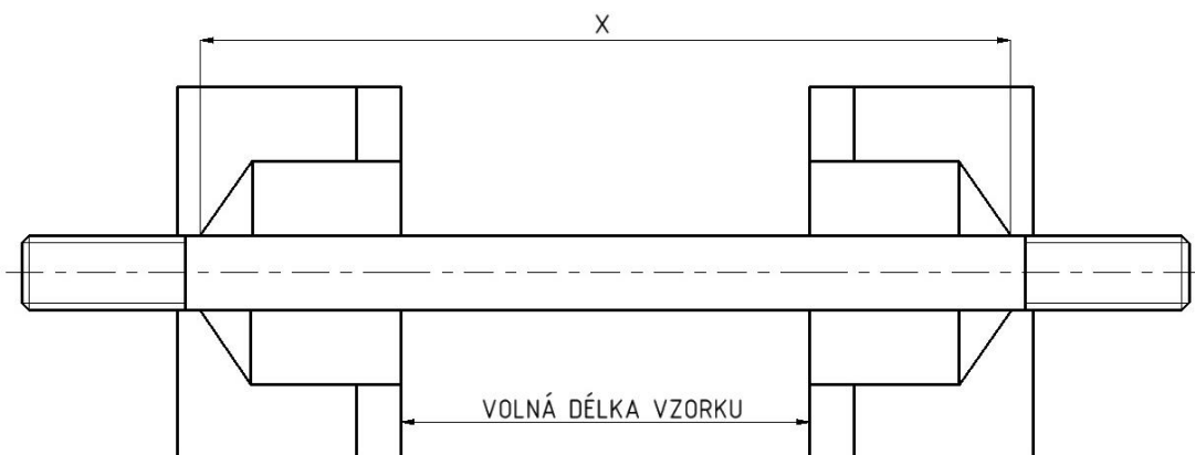
Obr. 2.14 Volná délka vzorku při upnutí součásti [19]
