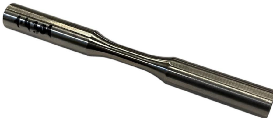
Obr. 3.13 Reálný vzorek pro únavovou cyklickou zkoušku
