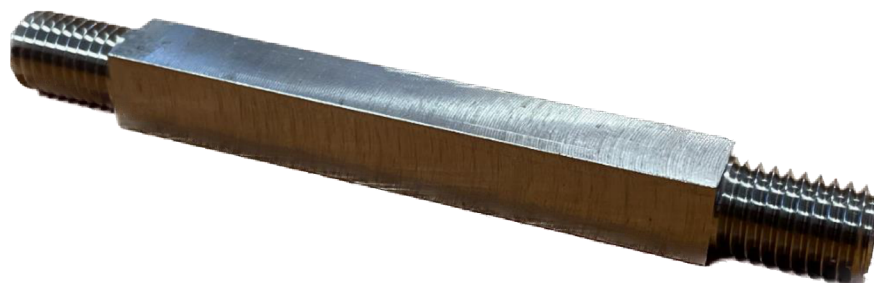
Obr. 3.2 Tvar vzorku využitý pro aplikaci teplotních cyklů a následné měření zbytkových napětí rentgenovou difrakcí
