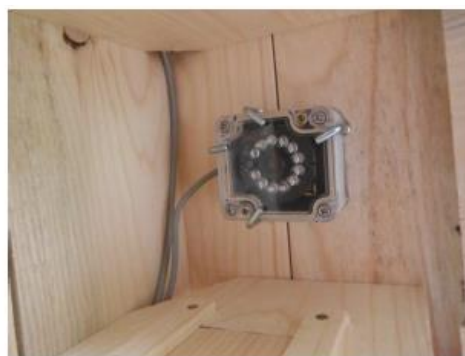
Obrázek 15. Přichycení horní kamery šroubovacími háky, kabel protažen otvorem do technické komory společně s kabelem IR brány (Zárybnická unpublik data).
