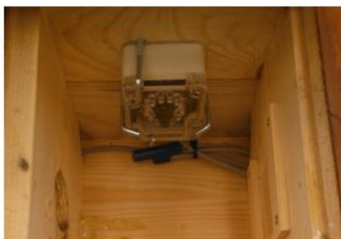
Obrázek 14. Teplotní čidlo, mikrofon a senzor intenzity světla jsou umístěny poblíž kamery (Zárybnická unpublik data).
