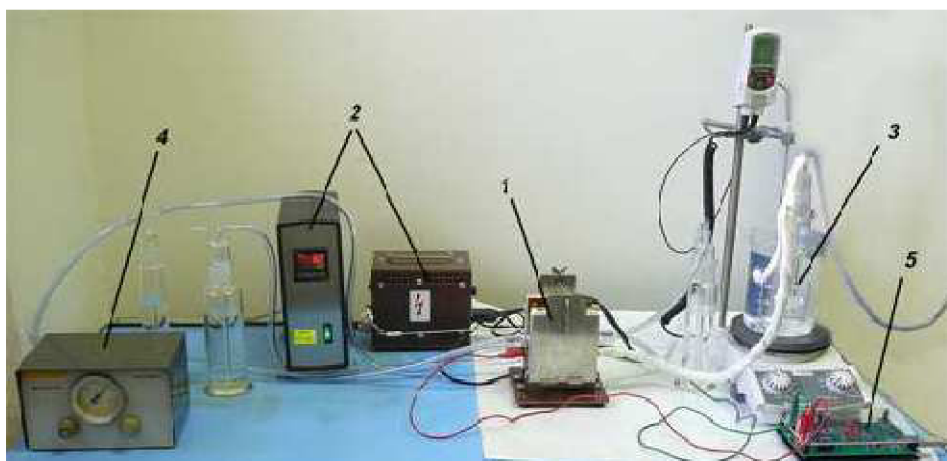
Obr. 3.4: Zapojení palivového článku. 1) palivový článek Quintech 2) regulátor a zdroj pro tepelný ohřev 3) vyhřívání zvlhčovací bublačky 4) Manostat 5) proměřovací sběrnice
