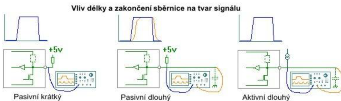
Obr. 1.6: Vliv délky a zakončení sběrnice na tvar impulsů
