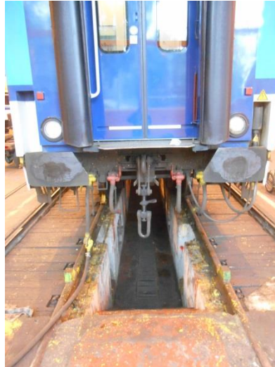
Obr. č. 13: Prostor pro opravu a údržbu podvozku vlaků (Skokan, 9/2015)
