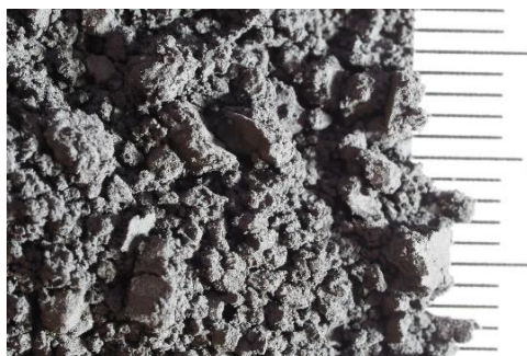
Obrázek č. 36 Detailní foto Micrographite C4, jeden díl= 1 mm, (foto autora)
