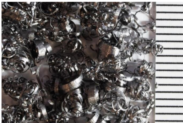
Obrázek č. 46 Detailní foto ocelových pilin, jeden dílek =1 mm (foto autora)
