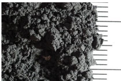
Obrázek č. 38 Detailní foto Condufit F8, jeden díl= 1 mm, (foto autora)
