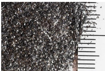
Obrázek č. 30 Detailní foto Supragraphite C300, jeden díl= 1 mm, (foto autora)
