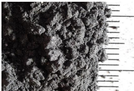
Obrázek č. 42 Detailní foto „filtr mazačka“, jeden díl= 1 mm, (foto autora)
