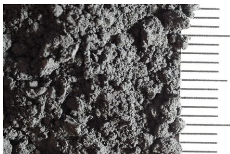
Obrázek č. 40 Detailní foto Condufit C4, jeden díl= 1 mm, (foto autora)
