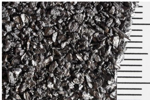
Obrázek č. 28 Detailní foto Supragraphite UC 700, jeden díl= 1 mm, (foto autora)
