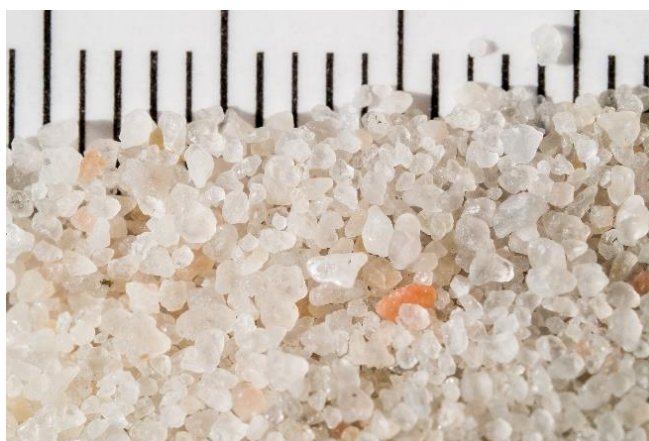
Obrázek č. 25 Detailní foto písku PR 30/31, jeden dílek = 1 mm (foto autora)
