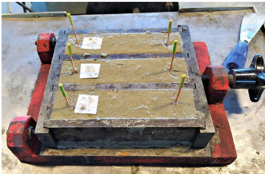
Obrázek č. 19 Troj forma se vzorky osazenými elektrodami pro měření impedance
