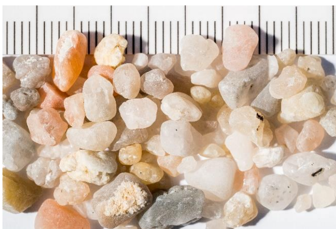
Obrázek č. 24 Detailní foto písku PR 1.6-4, jeden dílek =1 mm (foto autora)
