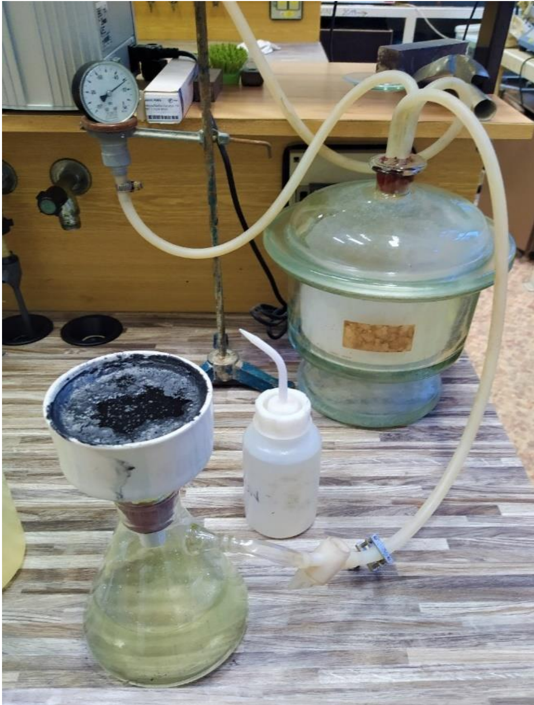
Obrázek č. 16 Měření nasákavosti dle ČSN EN 13055 (D) (foto autora)
