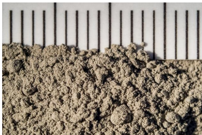
Obrázek č. 23 Detailní foto cementu CEM I 42,5R Mokrý, jeden dílek = 1 mm (foto autora)
