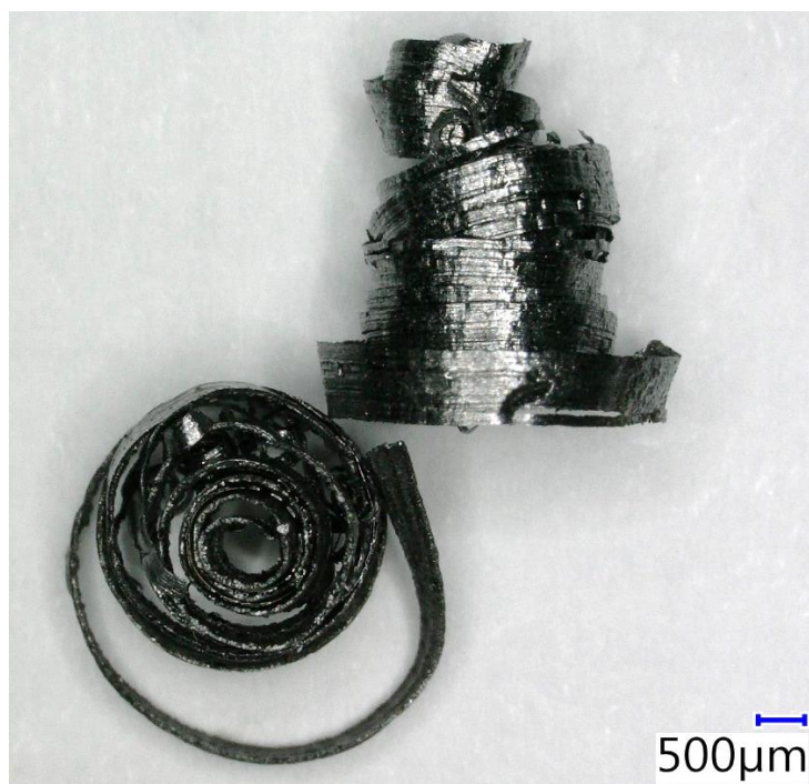
Obrázek č. 47 Detailní foto částic ocelových pilin, (foto autora)
