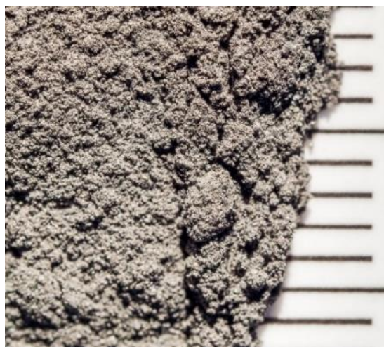
Obrázek č. 48 Detailní foto popílku ArcelorMittal, jeden dílek = 1 mm (foto autora)
