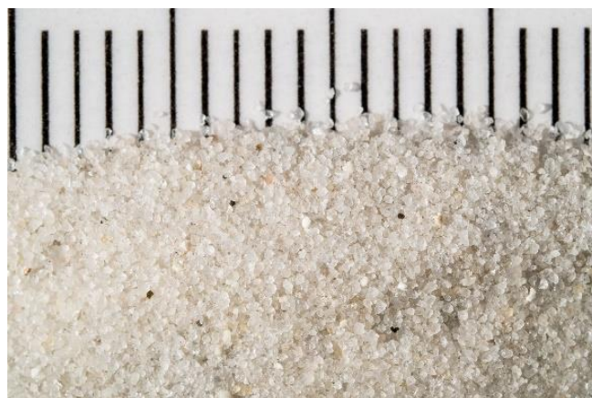
Obrázek č. 26 detailní foto písku PR 35, jeden dílek = 1 mm (foto autora)
