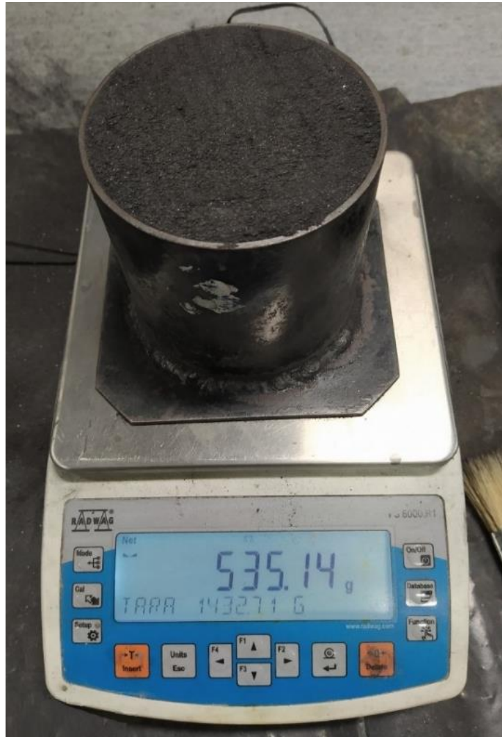
Obrázek č. 14 Měření sypných hmotností kameniva (foto autora)
