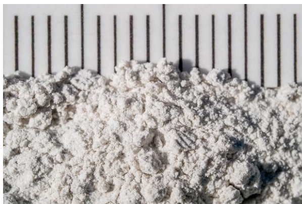
Obrázek č. 27 Detailní foto Vápence VBS 40, jeden dílek =1 mm (foto autora)
