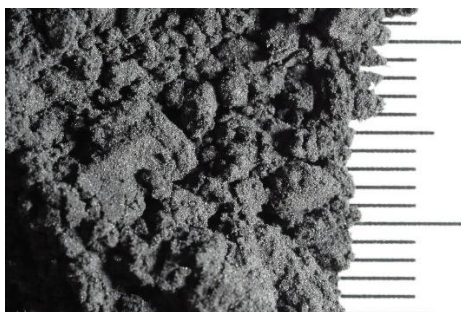
Obrázek č. 32 Detailní foto Micrographite F10, jeden díl= 1 mm, (foto autora)
