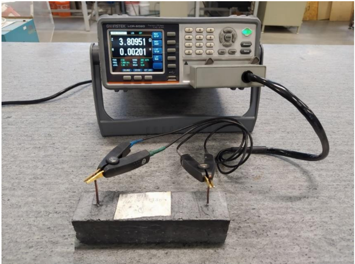
Obrázek č. 22 Měření impedance těles pomocí přístroje GW Instek LCR-6020 (foto autora)
