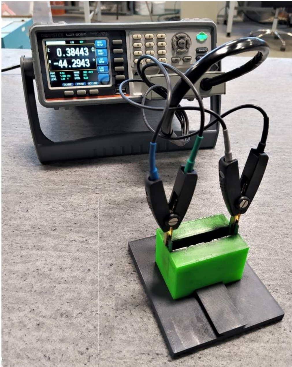
Obrázek č. 13 Měření impedance grafitového prášku, Foto autora
