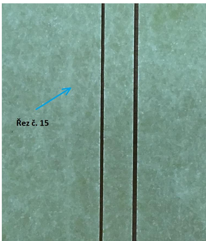
Obr. 6.24: Řezy č. 13 (zprava) až 15 (zleva) výstupní strany kompozitní desky o tloušťce 4 mm.
