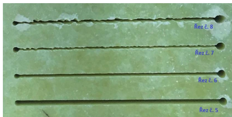
Obr. 6.36: Řezy č. 5-8 na výstupní straně kompozitní desky o tloušťce 20 mm.
