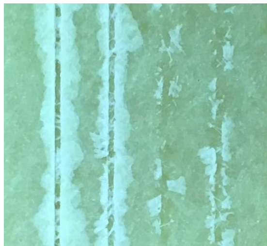
Obr. 6.18: Řezy č. 9 (zleva) až 12 (zprava) vstupní strany kompozitní desky o tloušťce 4 mm.
