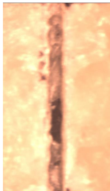
Obr. 6.29: Řez č. 4 kompozitní desky o tloušťce 20 mm, vstupní strana desky.
