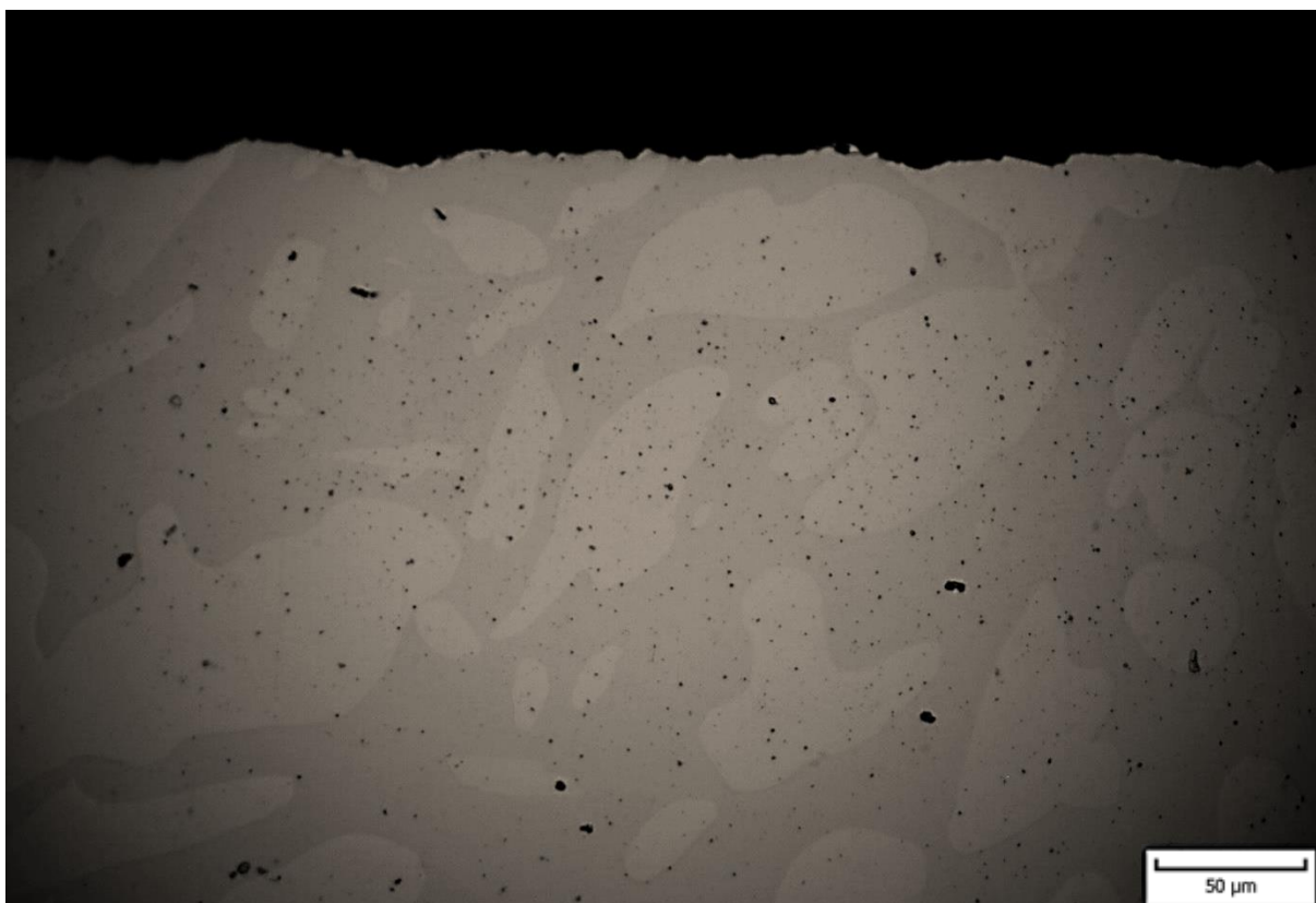
Obr. 42 Mikrostruktura vzorku z duplexní oceli (zvětšení 400x)
