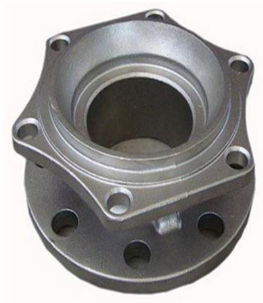
Obr. 4 Odlitek z austenitické LLG odlévaný metodou přesného lití [12]
