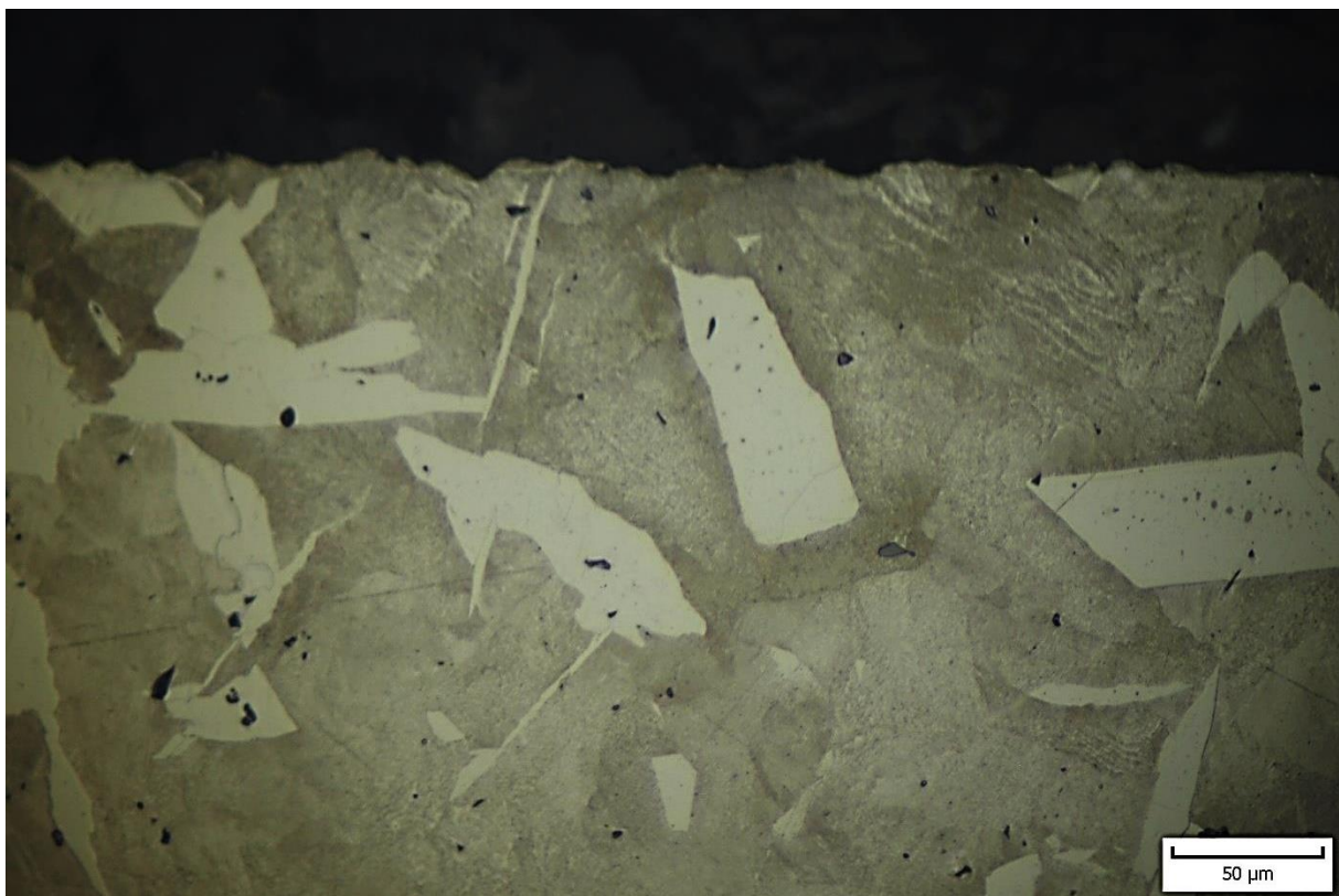
Obr. 40 Mikrostruktura vzorku z uhlíkové oceli (zvětšení 400x)
