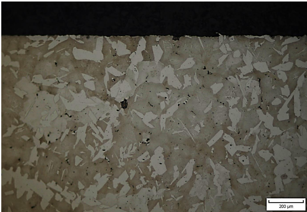
Obr. 39 Mikrostruktura vzorku z uhlíkové oceli (zvětšení 100x)
