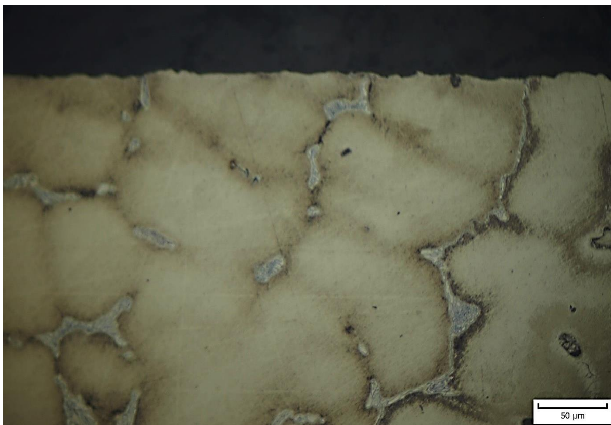
Obr. 44 Mikrostruktura vzorku z Cr-Ni oceli (zvětšení 400x)
