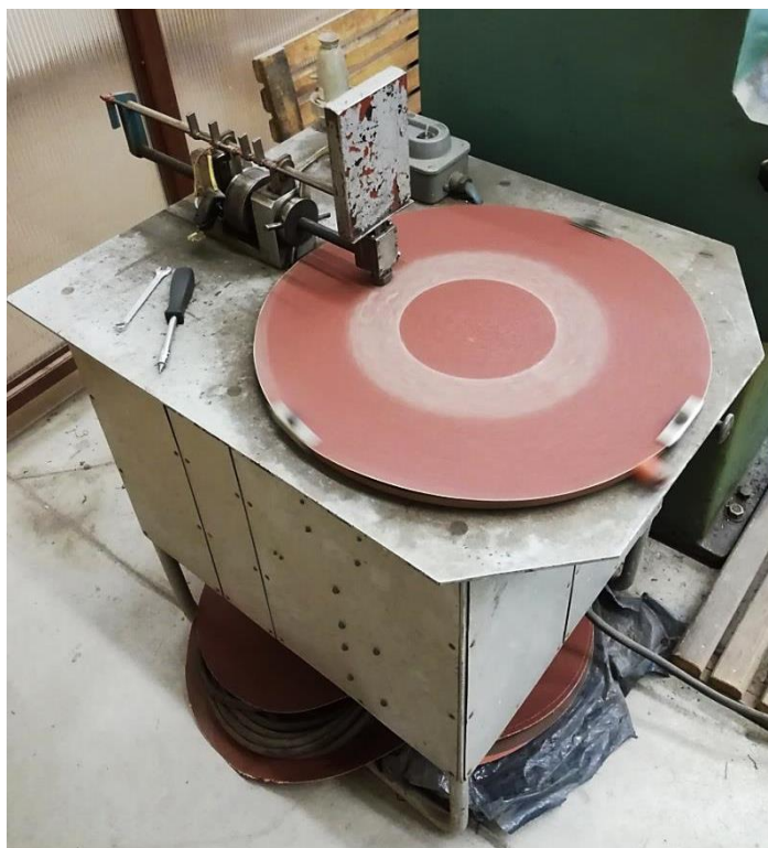
Obr. 21 Příklad přístroje na měření opotřebení na brusném plátně na Mendelově univerzitě v Brně
