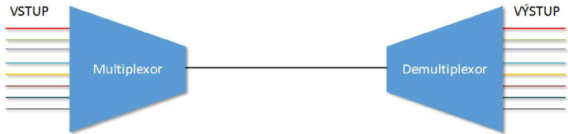
Obr. 4.5: Princíp WDM multiplexu
