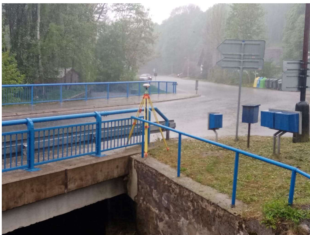
Obr. 2.2.3-1: Anténa R8s během měření v kampani 2022 na bodě DMO2 zasažen přívalovým deštěm zhruba uprostřed observace (14.05.2022)
