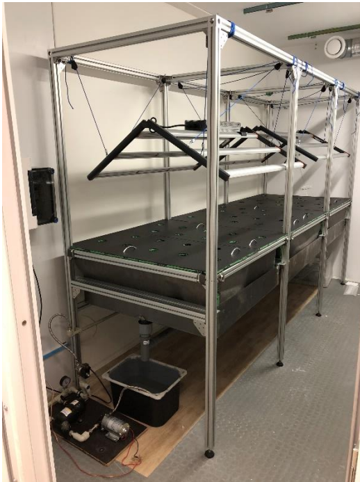
Obrázek 11: Nově zhotovená aeroponická jednotka
