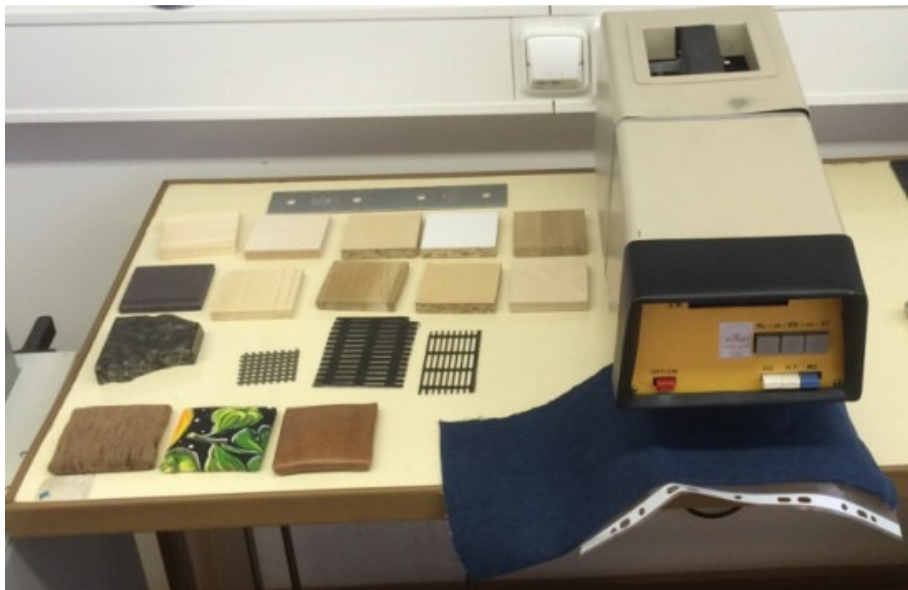
Obrázek č. 23 - Přístroj Alambeta se vzorky a denimovou tkaninou
