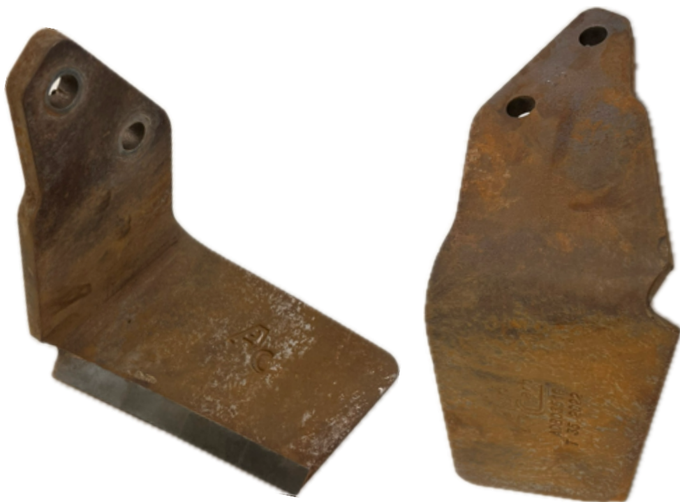
Obrázek 31 Křídélko ADB 0351G T35 (opotřebené), výrobce AGRICARB, neoriginální díl
