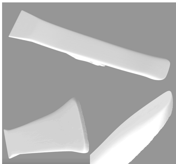
Obrázek 35 3D sken opotřebeného nezušlechtěného oboustranného originálního dláta KM 060 415
