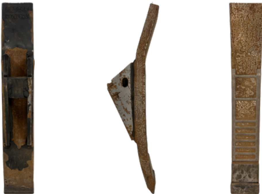
Obrázek 19 Dláto KM 060 540 (opotřebené), výrobce BETEK, originální díl
