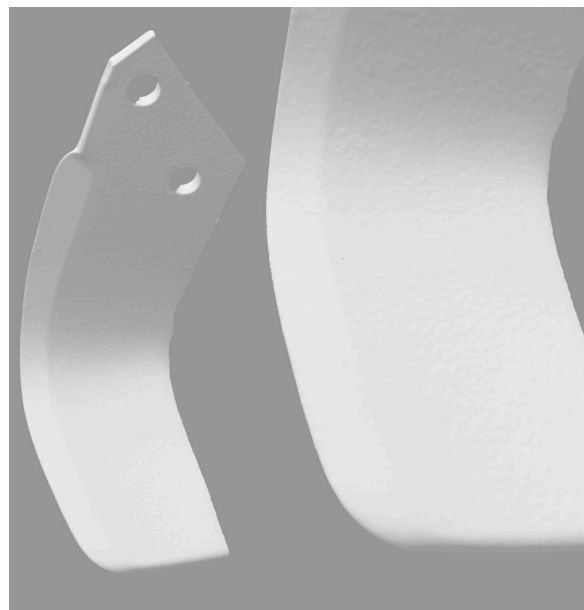
Obrázek 43 3D sken opotřebeného nezušlehtěného originálního křídélka ZA KM 060 350 č.20 (EUROZAPPA)
