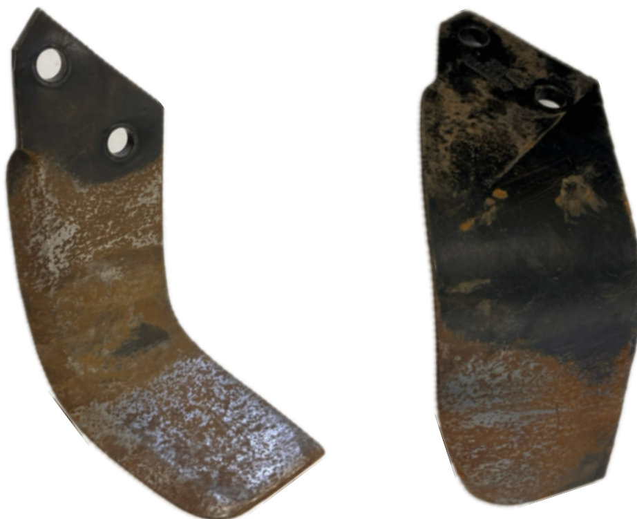
Obrázek 26 Křidélko ZA KM 060 350 (opotřebené), výrobce EUROZAPPA, originální díl
