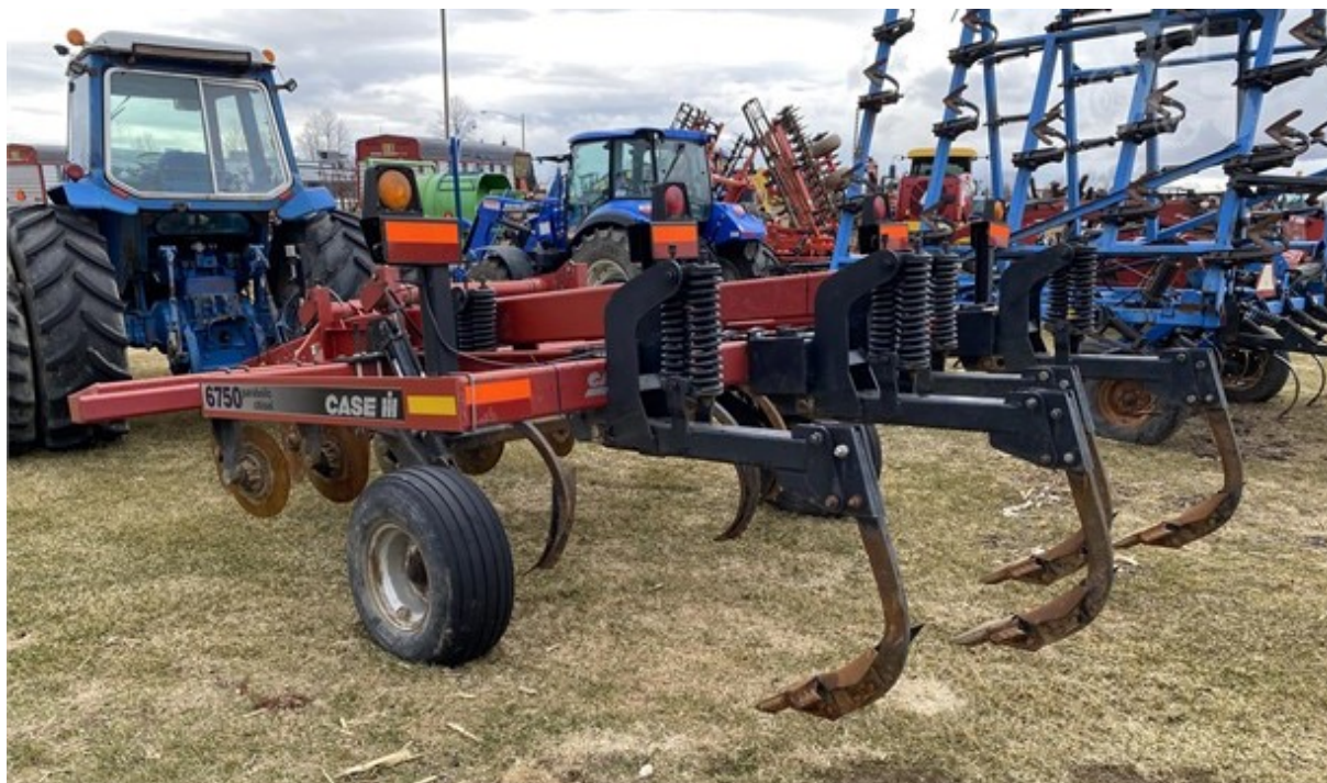
Obrázek 6 Ukázka parabolického dláta na stroji CASE IH 6750 (44)
