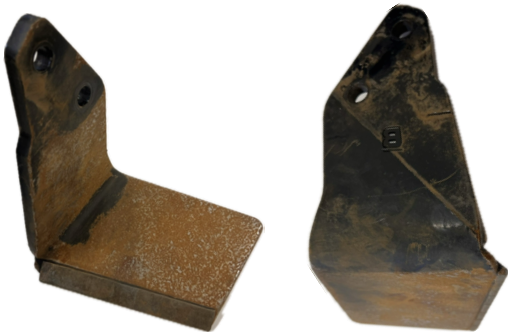
Obrázek 29 Křídélko KM 060 484 (opotřebené), výrobce BETEK, originální díl
