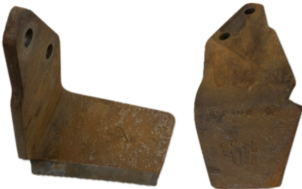
Obrázek 30 Křídélko ADB 0351D T35 (opotřebené), výrobce AGRICARB, neoriginální díl
