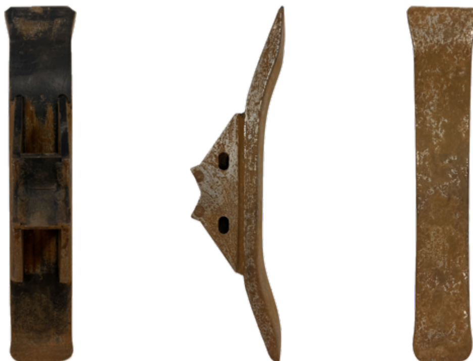
Obrázek 16 Dláto AMA CP7667 (opotřebené), oboustranné, výrobce AMA, neoriginální díl
