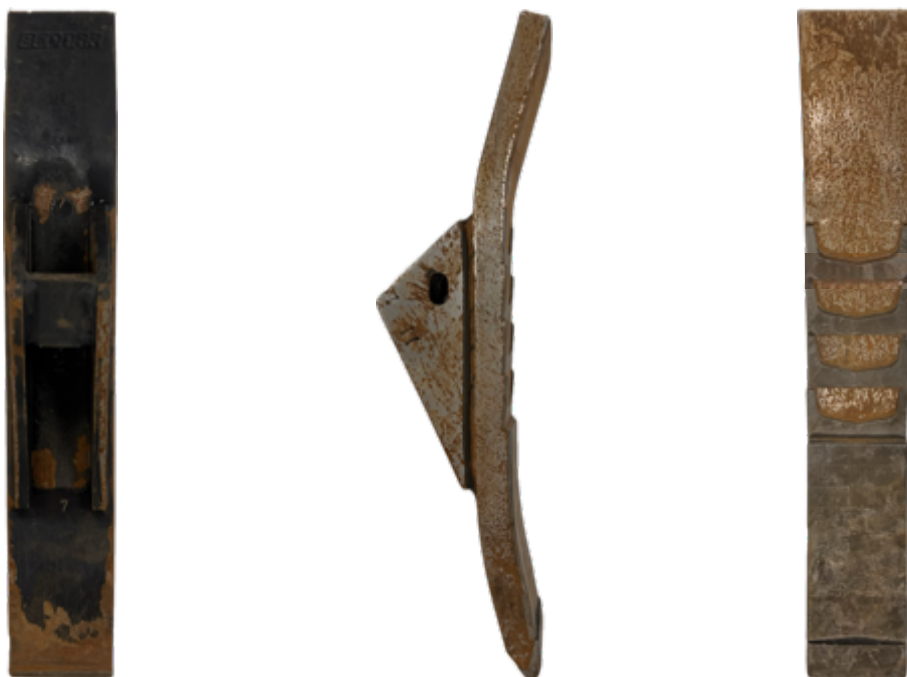
Obrázek 20 Dláto KM 060 411 (opotřebené), výrobce BETEK, originální díl
