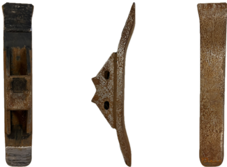
Obrázek 15 Dláto AMA CP7667R s tvrdokovovým návarem (opotřebené), oboustranné, výrobce AMA, neoriginální díl
