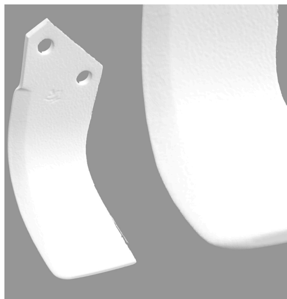
Obrázek 43 3D sken opotřebeného nezušlehtěného neoriginálního křídélka IQ PARTS
