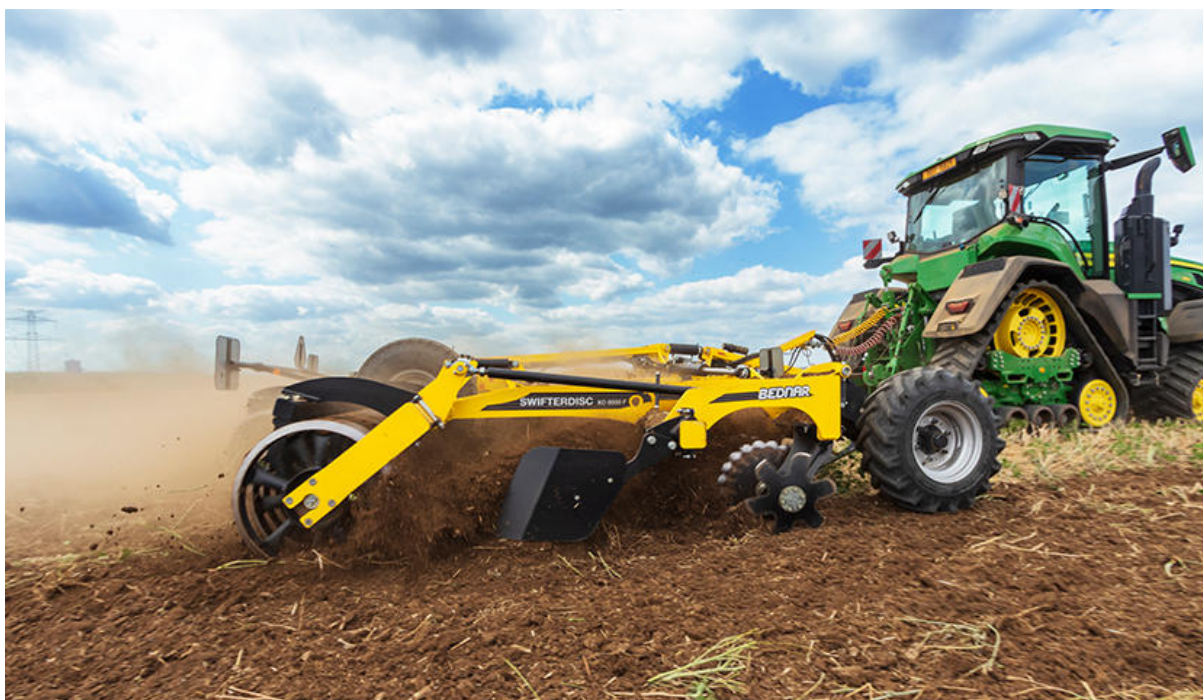
Obrázek 11 Bezorebné zpracování půdy kypřičem BEDNAR (17)
