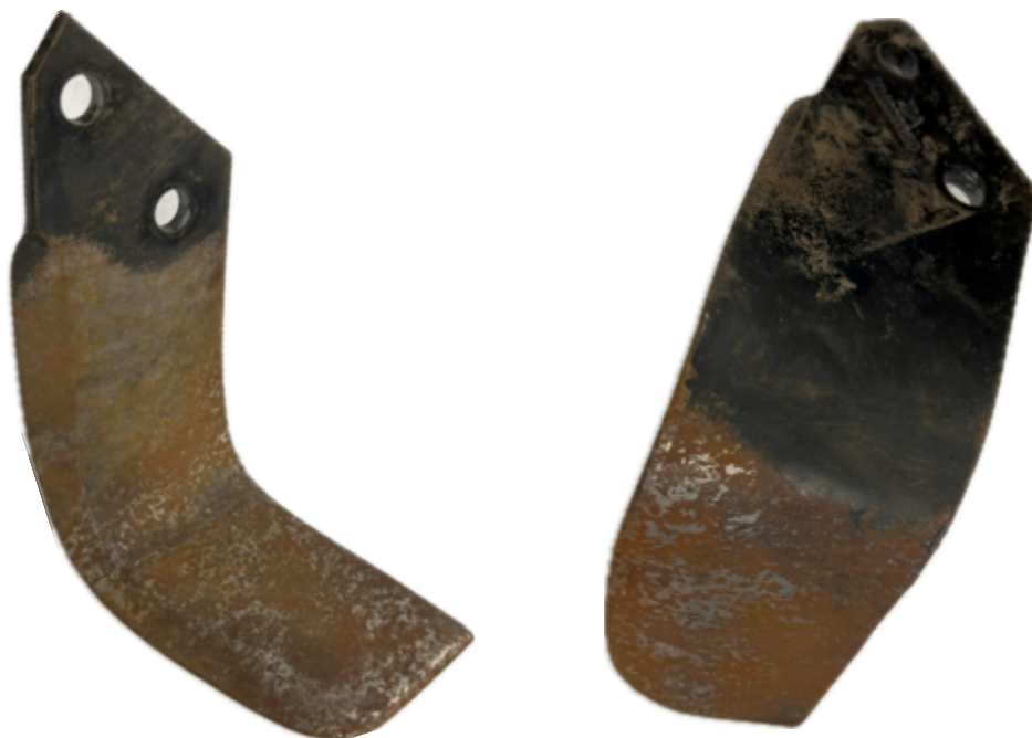
Obrázek 22 Křídélko ZA KM 060 350 (opotřebené), výrobce EUROZAPPA, originální díl
