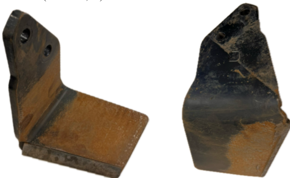
Obrázek 28 Křídélko KM 060 483 (opotřebené), výrobce BETEK, originální díl
