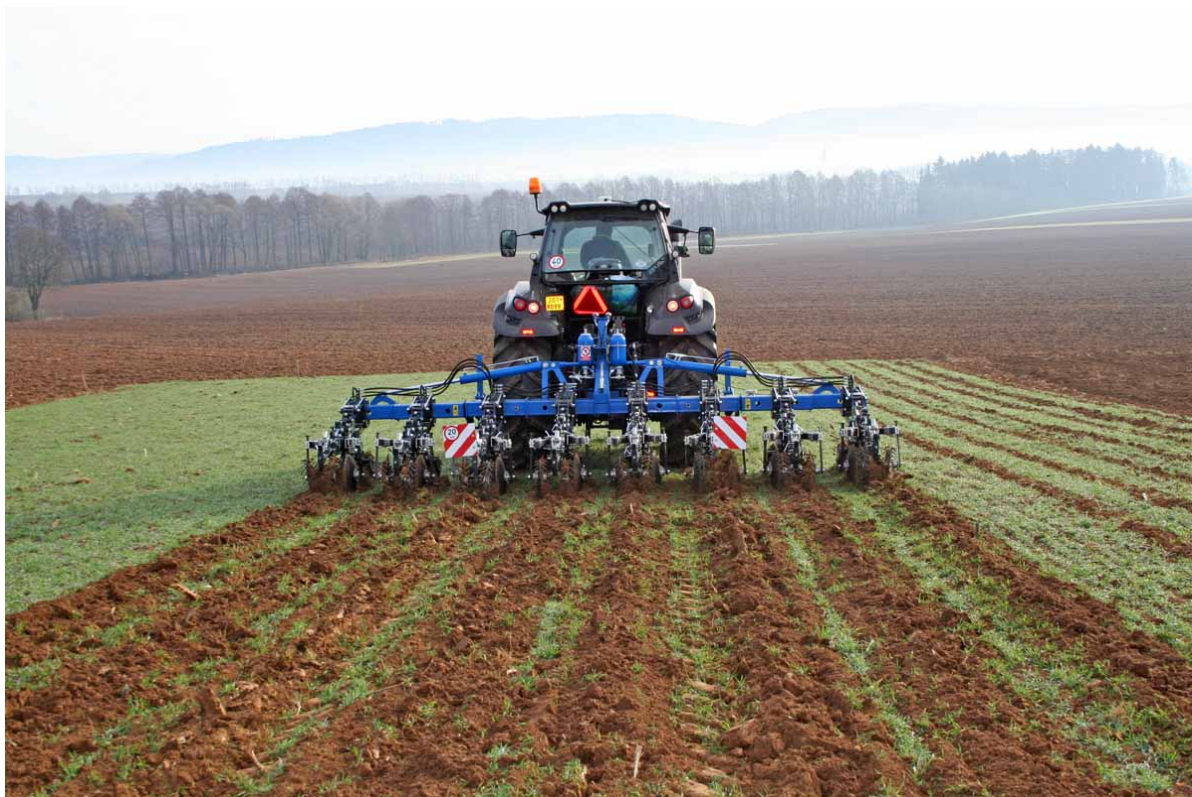
Obrázek 12 Jarní termín pásového zpracování porostu žita setého strojem Eco Tiller 600 (41)
