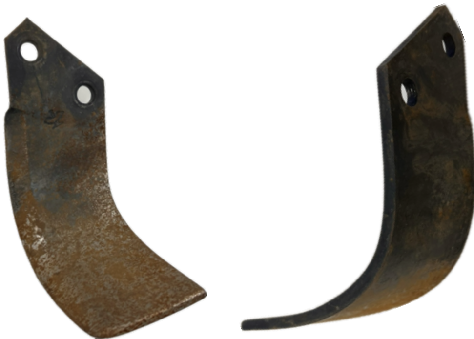
Obrázek 25 Křidélko IQ PARTS (opotřebené), výrobce IQ PARTS, neoriginální díl
