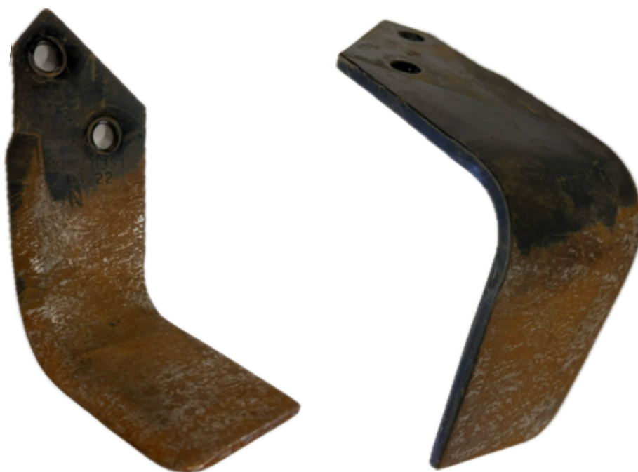
Obrázek 23 Křídélko KM 060 351 0322N (opotřebené), výrobce EUROZAPPA, originální díl
