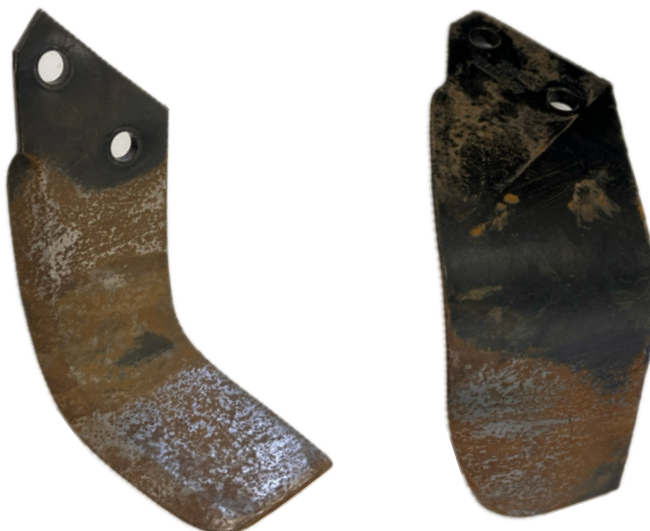
Obrázek 26 Křidélko ZA KM 060 350 (opotřebeně), výrobce EUROZAPPA, originální díl
