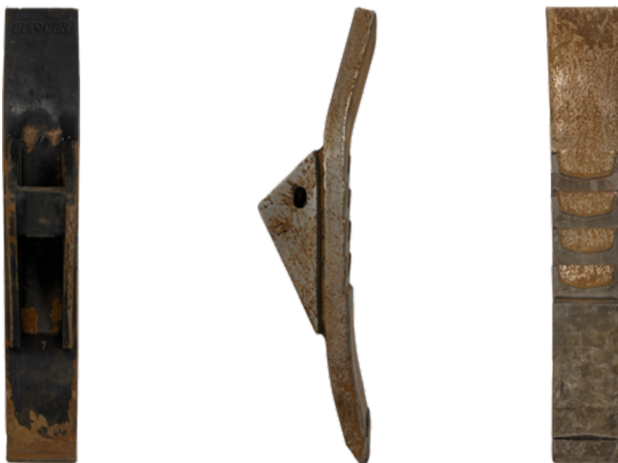
Obrázek 20 Dláto KM 060 411 (opotřebené), výrobce BETEK, originální díl
