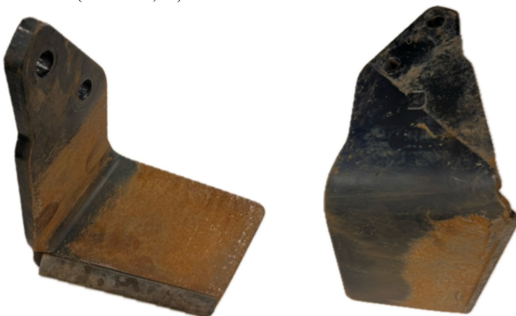
Obrázek 28 Křídélko KM 060 483 (opotřebené), výrobce BETEK, originální díl
