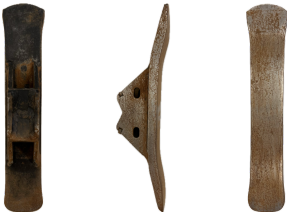
Obrázek 17 Dláto KM 060 171 T09 (opotřebené), oboustranné, výrobce IQ PARTS, neoriginální díl
