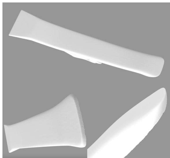
Obrázek 35 3D sken opotřebeného nezušlechtného oboustranného originálního dláta KM 060 415
