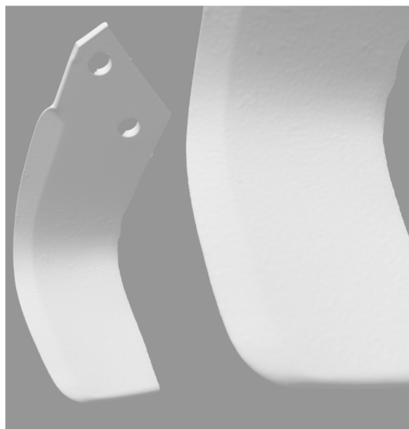
Obrázek 43 3D sken opotřebeného nezušlechtěného originálního křídélka ZA KM 060 350 č.20 (EUROZAPPA)
