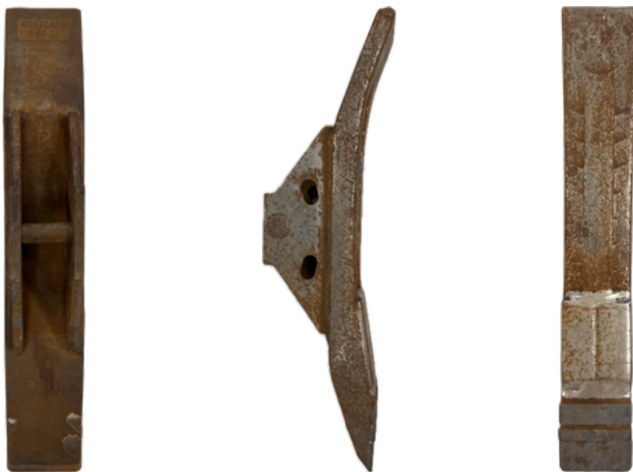
Obrázek 21 Dláto AGRICARB R40-22 (opotřebené), výrobce AGRICARB, neoriginální díl
