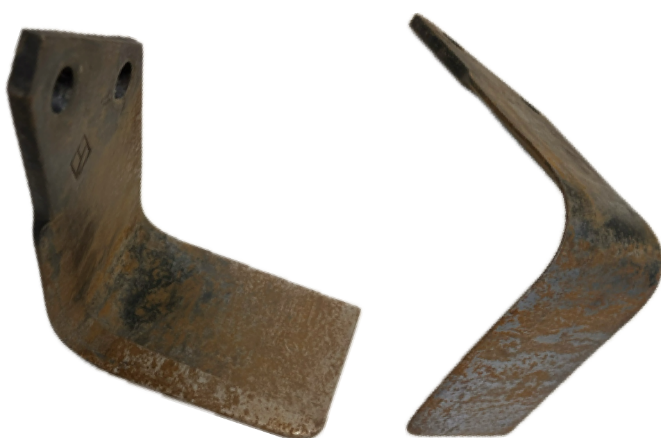
Obrázek 24 Křídélko INDUSTRIE HOF (opotřebené), výrobce INDUSTRIE HOF, neoriginální díl
