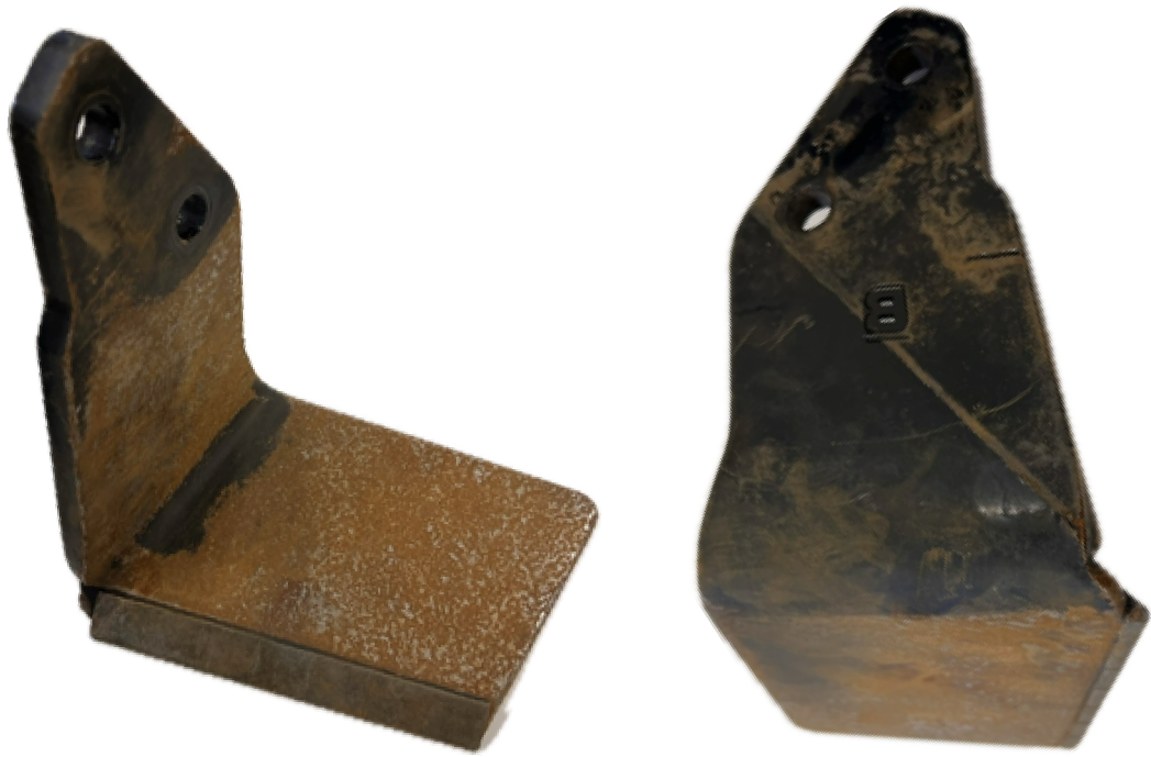
Obrázek 29 Křídélko KM 060 484 (opotřebené), výrobce BETEK, originální díl
