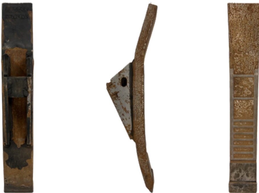
Obrázek 19 Dláto KM 060 540 (opotřebené), výrobce BETEK, originální díl
