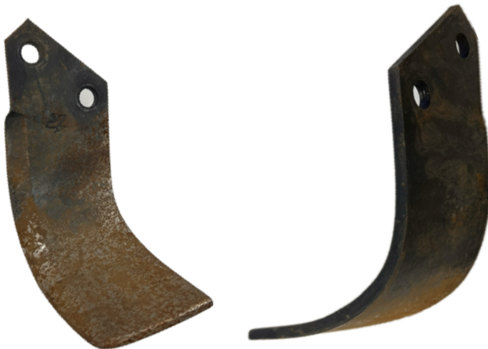
Obrázek 25 Křidélko IQ PARTS (opotřebeně), výrobce IQ PARTS, neoriginální díl
