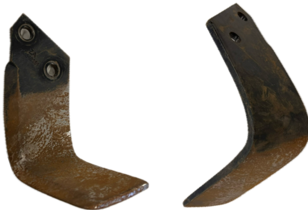
Obrázek 27 Křídélko ZA KM 060 351 (opotřebené), výrobce EUROZAPPA, originální díl
