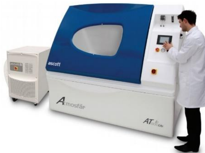
Obrázek č. 11: Solná korozní komora Ascott Atmosfär [20]
