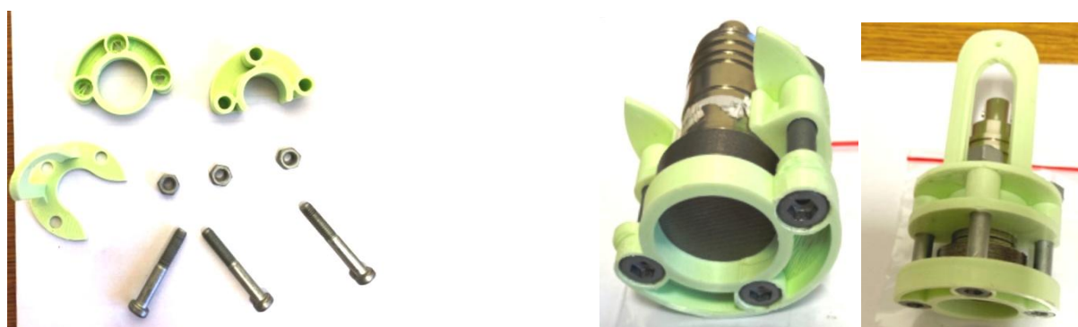
Obrázek č. 46: Přípravek pro umístění vzorků do kondenzační komory (vlevo rozložený, vpravo s upnutým vzorkem) [vlastní foto]
