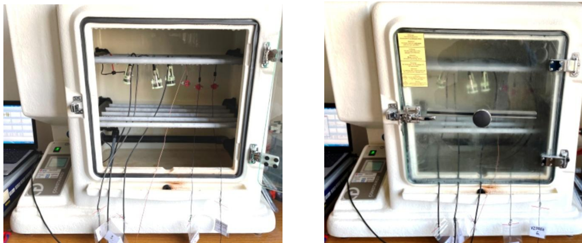
Obrázek č. 47: Vzorky umístěné v kondenzační komoře [vlastní foto]
