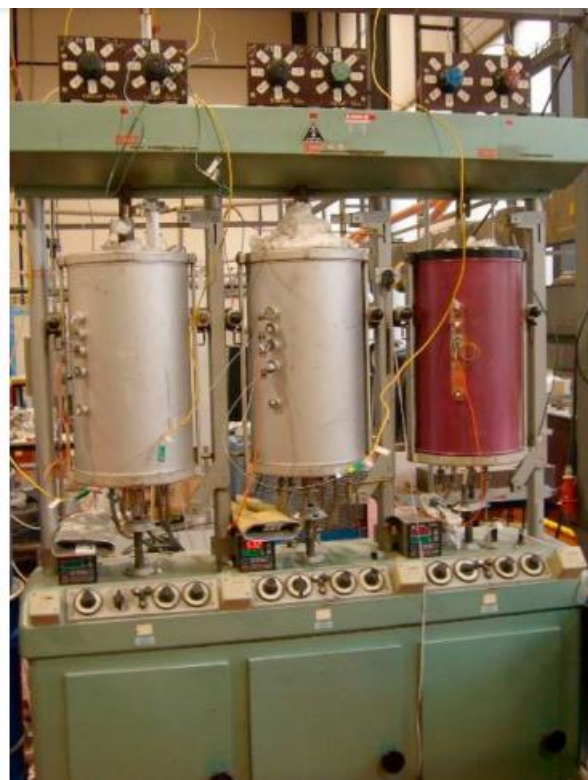
Obrázek č. 22: 3pozicový stroj pro creepovou zkoušku Zst 2/3 [26]
