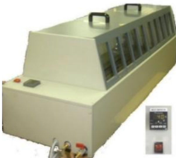
Obrázek č. 10: Kondenzační komora Elcometer [19]
