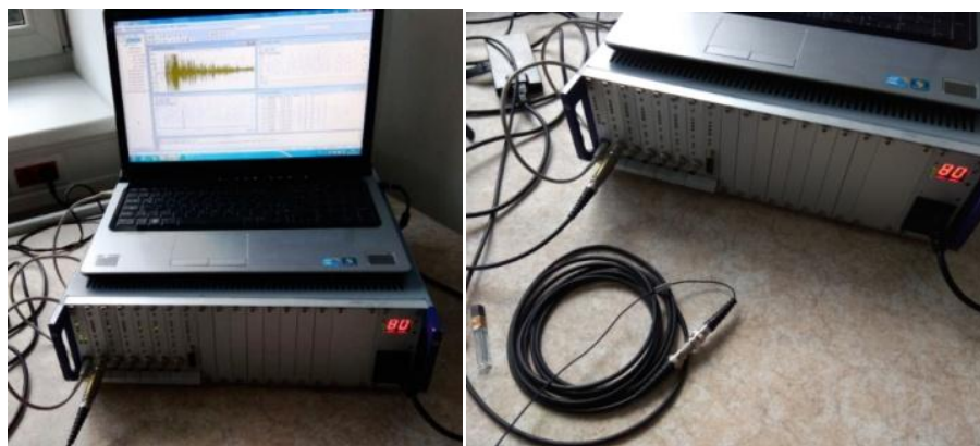
Obrázek č. 84: Systém pro měření akustické emise Dakel Xedo
