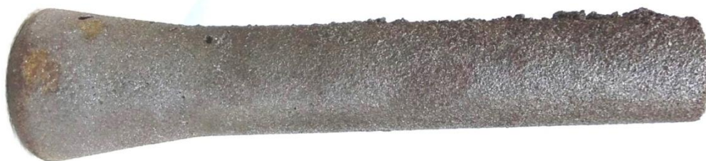
Obrázek č. 43: Původní opískovaný vzorek materiálu [vlastní foto]
