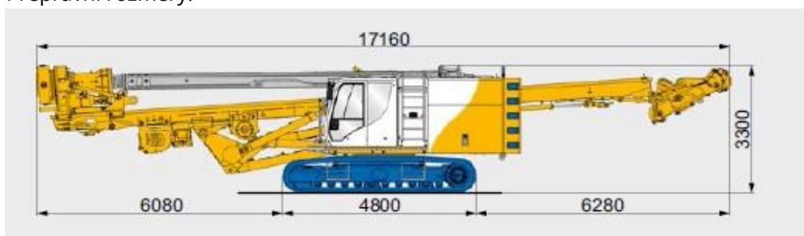
Obr. 6.2 - Přepravní délka vrtací soupravy BG 20 H [13]
