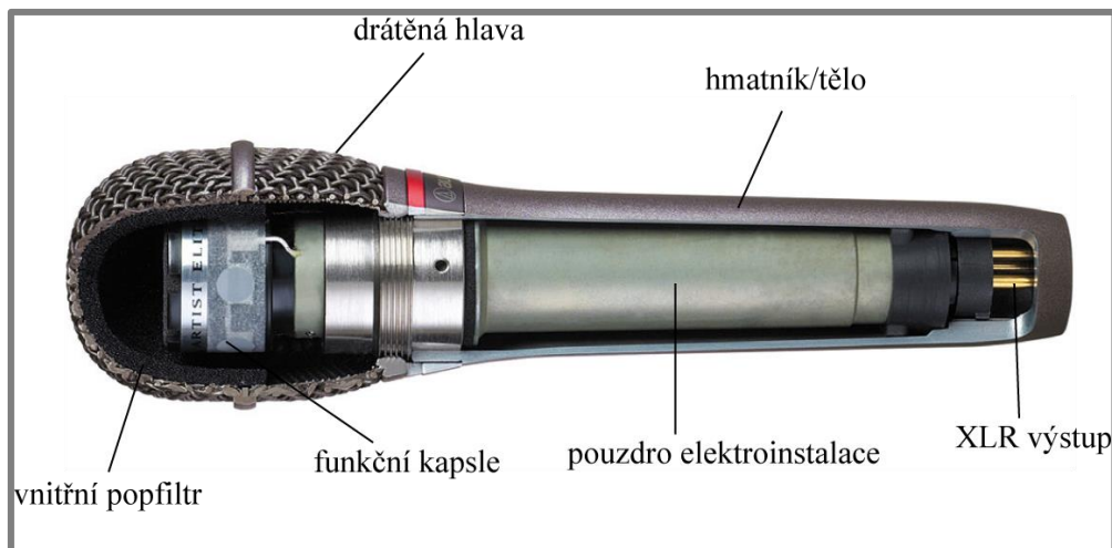
Obr. 2-5 Průřez a popis částí drátového mikrofonu AE6100 [46]
