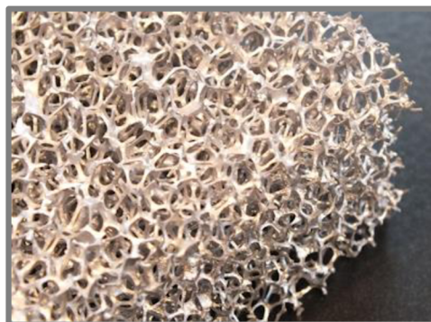
Obr. 6-3 Struktura hliníkové pěny RECEMAT® metalfoam [54]
