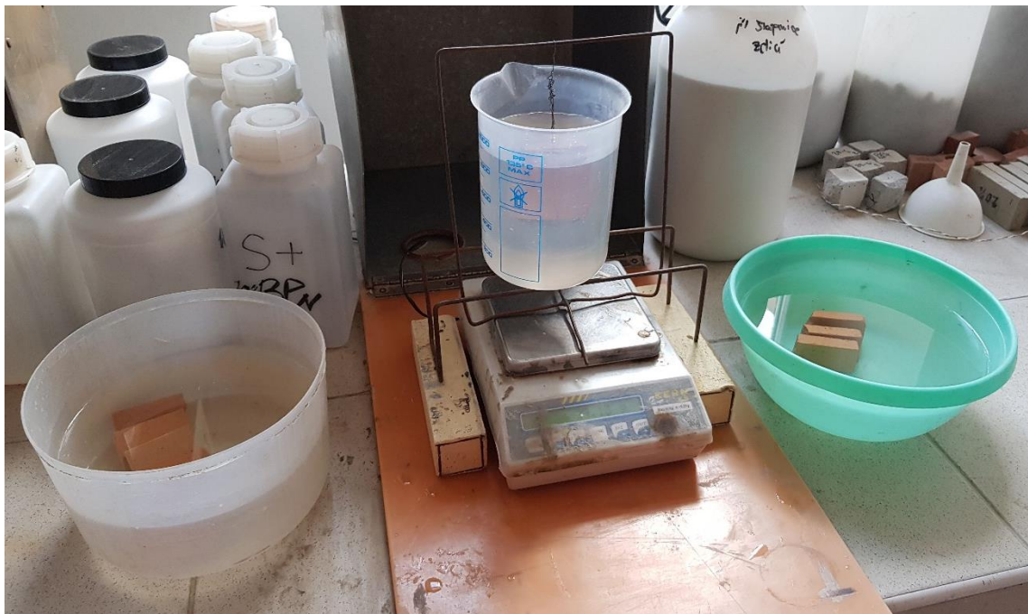
Obr. 6: Sestava pro hydrostatické vážení
