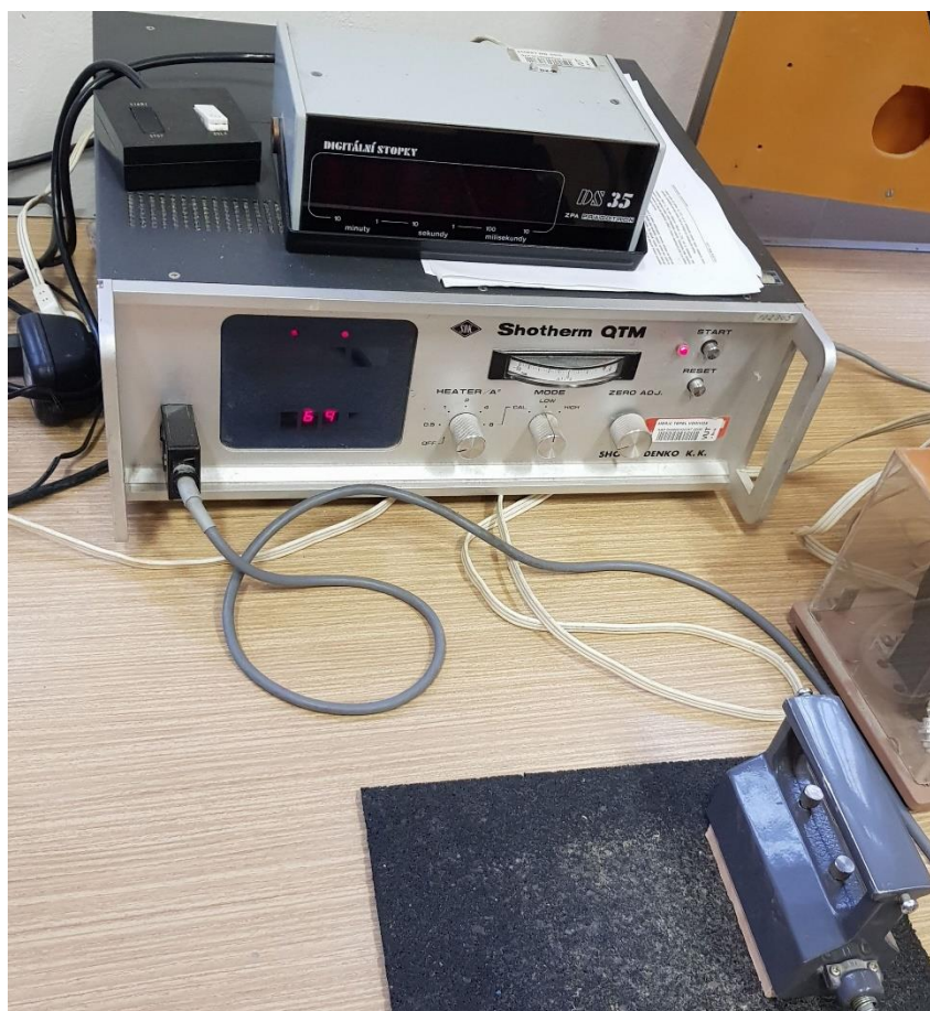
Obr. 3: měření tepelné vodivosti přístrojem Shotherm QTM
