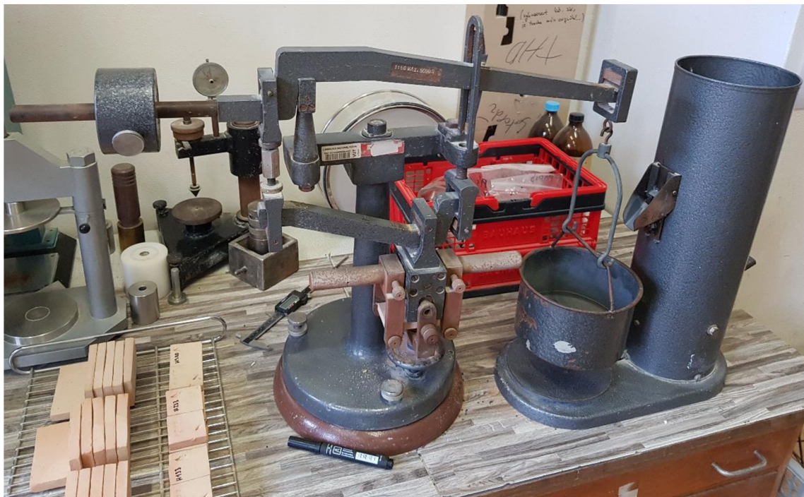
Obr. 4: stanovení pevnosti střepe v ohybu na Michaelisově přístroji
