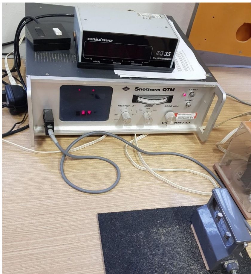
Obr. 3: měření tepelné vodivosti přístrojem Shotherm QTM
