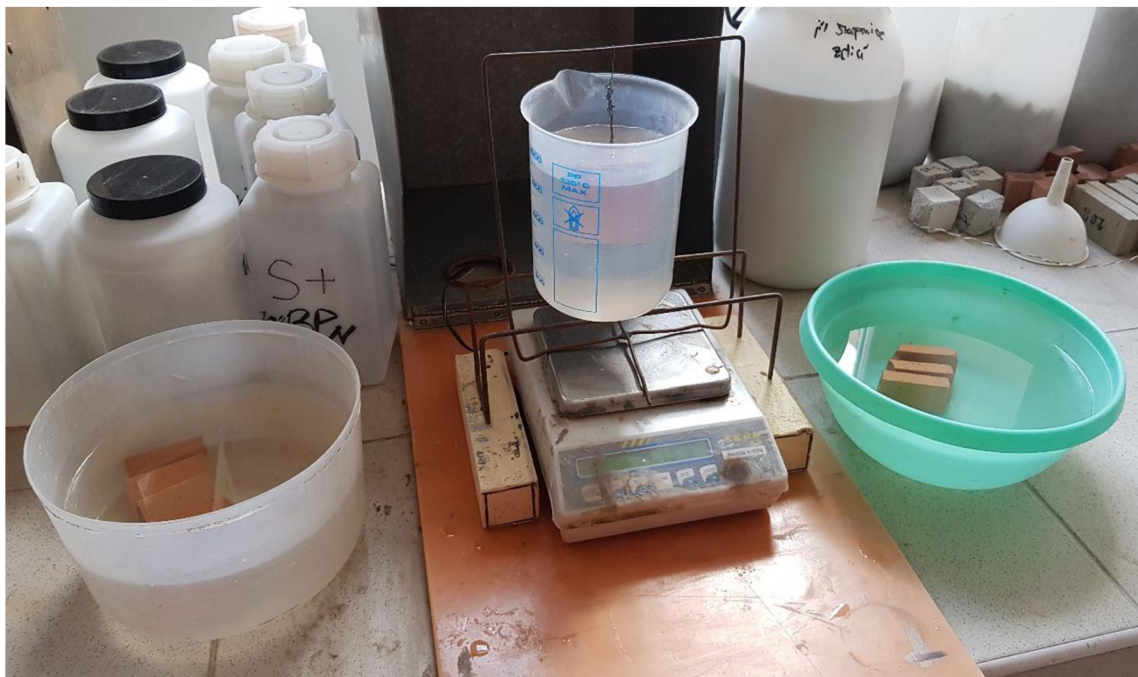
Obr. 6: Sestava pro hydrostatické vážení
