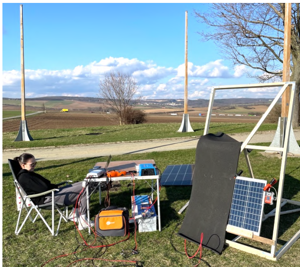
Obr. 30 Fotovoltaický panel Victron Energy SPP040601200 při 50 % zakrytí
