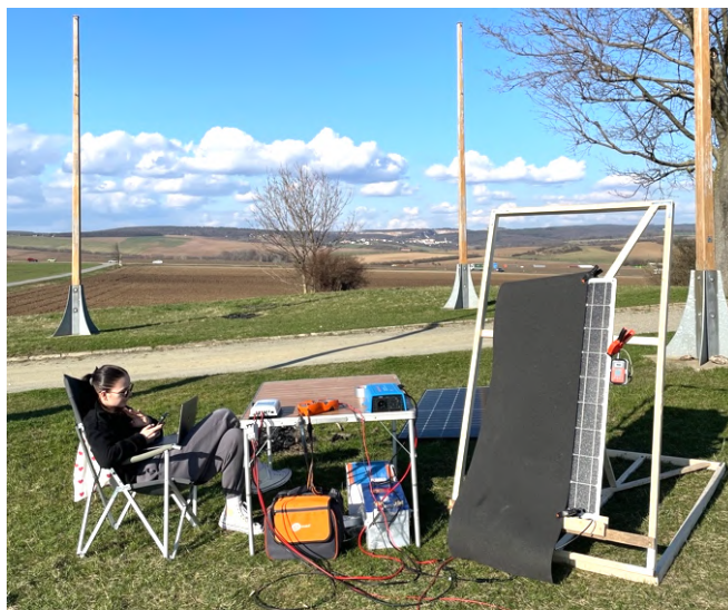
Obr. 31 Fotovoltaický panel Renogy RNG-100DB-H při 75 % zakrytí
