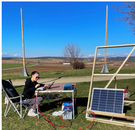
Obr. 22 Fotovoltaický panel Victron Energy SPP040601200 během měření
