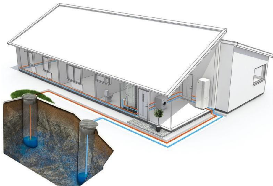
Obr. 6-5 Tepelné čerpadlo voda-voda (převzato z [25])
