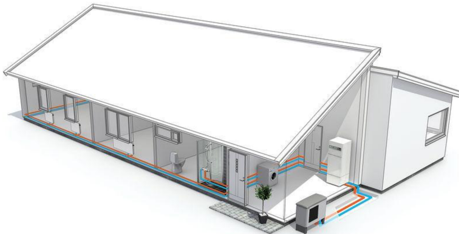
Obr. 6-2 Tepelné čerpadlo vzduch-voda (převzato z [25])
