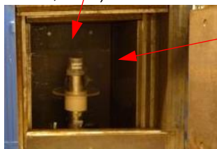
Obr. 18: Přenosný HPGe detektor se vzorkem v geometrii (zdroj: SÚRO, 2020)
