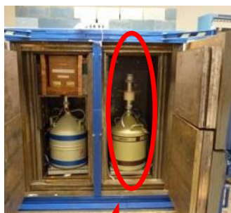
Obr. 17: Ocelová dvojkobka se 2 HPGe detektory. Jeden je navíc umístěn v dostínění z elektrolytické mědi (zdroj: SÚRO, 2020)
