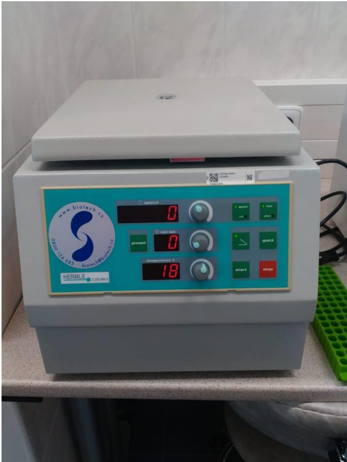
Obrázek č 6. Pečlivě vyvážená centrifuga. (Zdroj vlastní)
