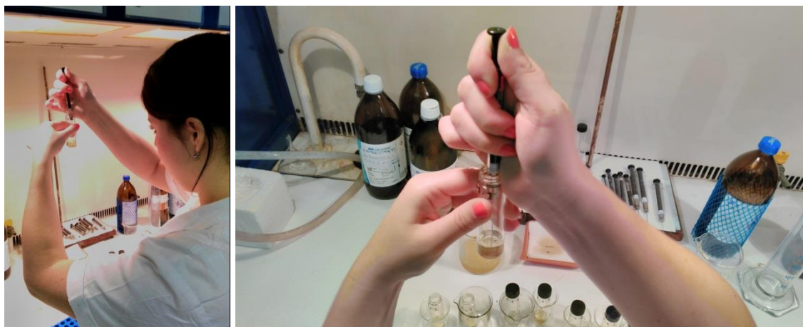
Obr. 10 Přechišťování vzorku pomocí koncentrované kyseliny sírové
