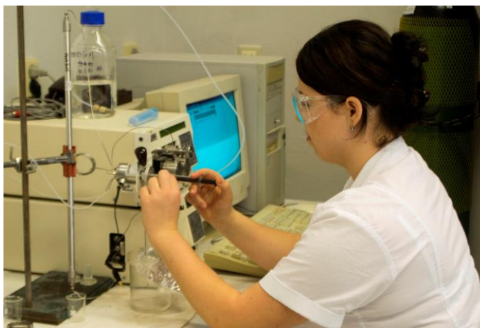
Obr. 9 Separace ko-extraktů od ftalátů pomocí gelové permeační chromatografie
