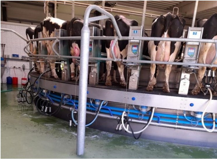
Příloha č. 1. paralelní rotační poloautomatická dojírna
