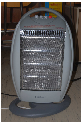
Obr. 18: Halogenový zářič jako zdroj tepelného toku
