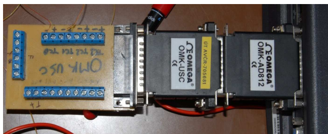
Obr. 23: Propojení OMK-AD812 s OMK-USC a počítačem
