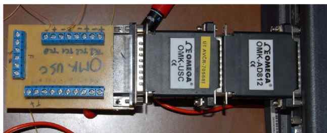
Obr. 23: Propojení OMK-AD812 s OMK-USC a počítačem
