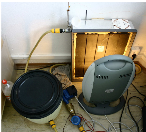
Obr. 19: Experimentální model solárního systému
