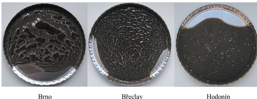
Obr. 7.4 Stanovení sušiny u surových anaerobně stabilizovaných kalů
