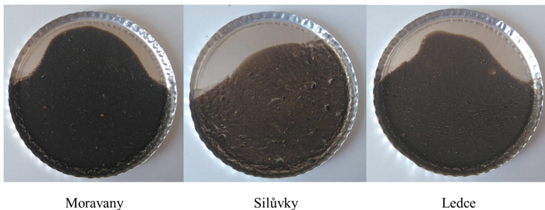
Obr. 7.6 Stanovení sušiny u surových aerobně stabilizovaných kalů
